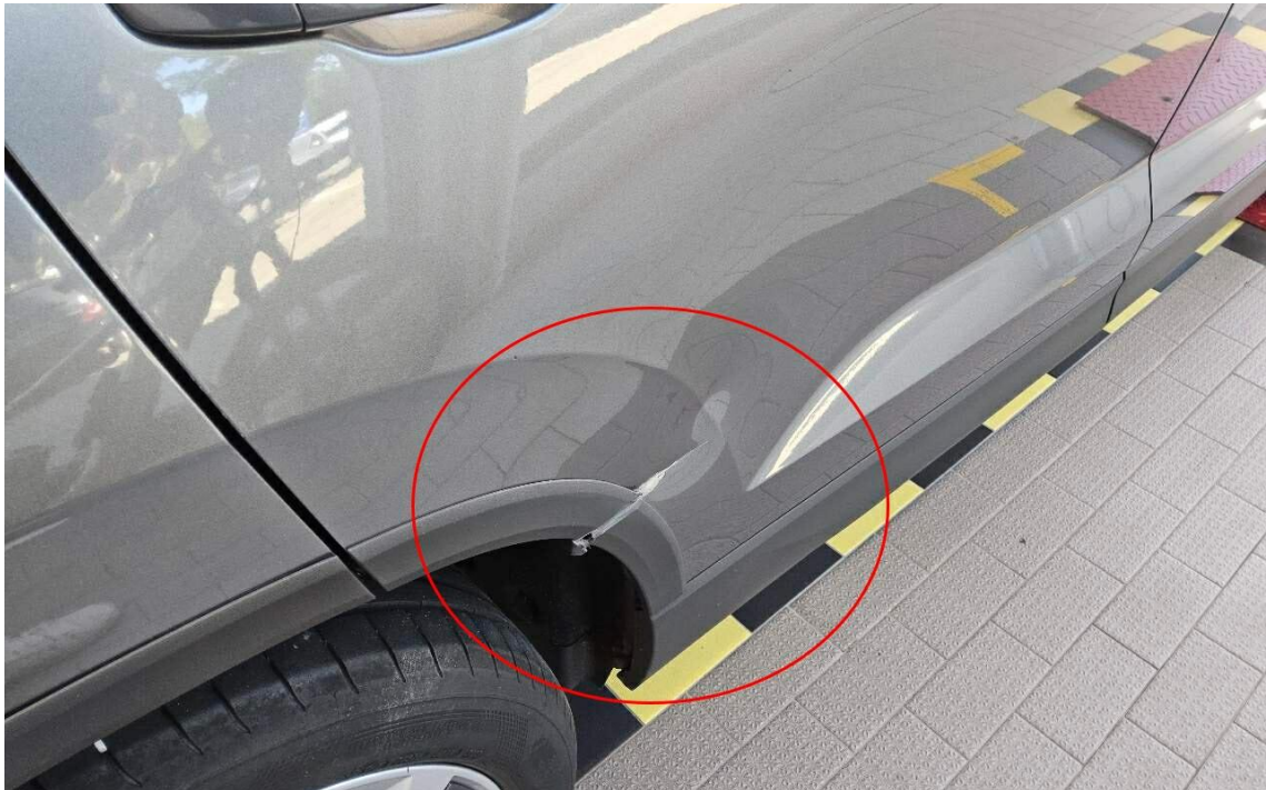
Bild 21 : Tür hinten rechts deformiert, Zierleiste beschädigt
