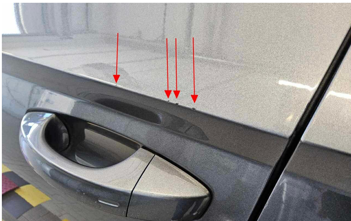
Bild 14 : Tür vorne links Türkante, Lackabplatzer, Gebrauchsspur
