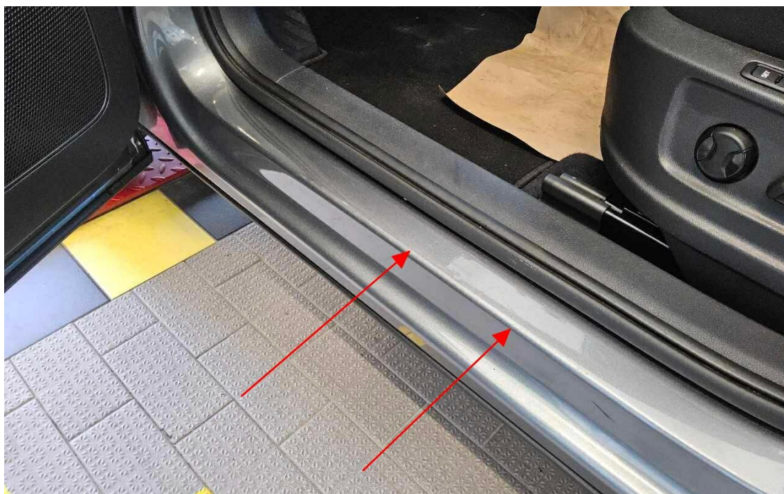
Bild 16 : Tür vorne links Einstieg, eingedellt, Gebrauchsspur
