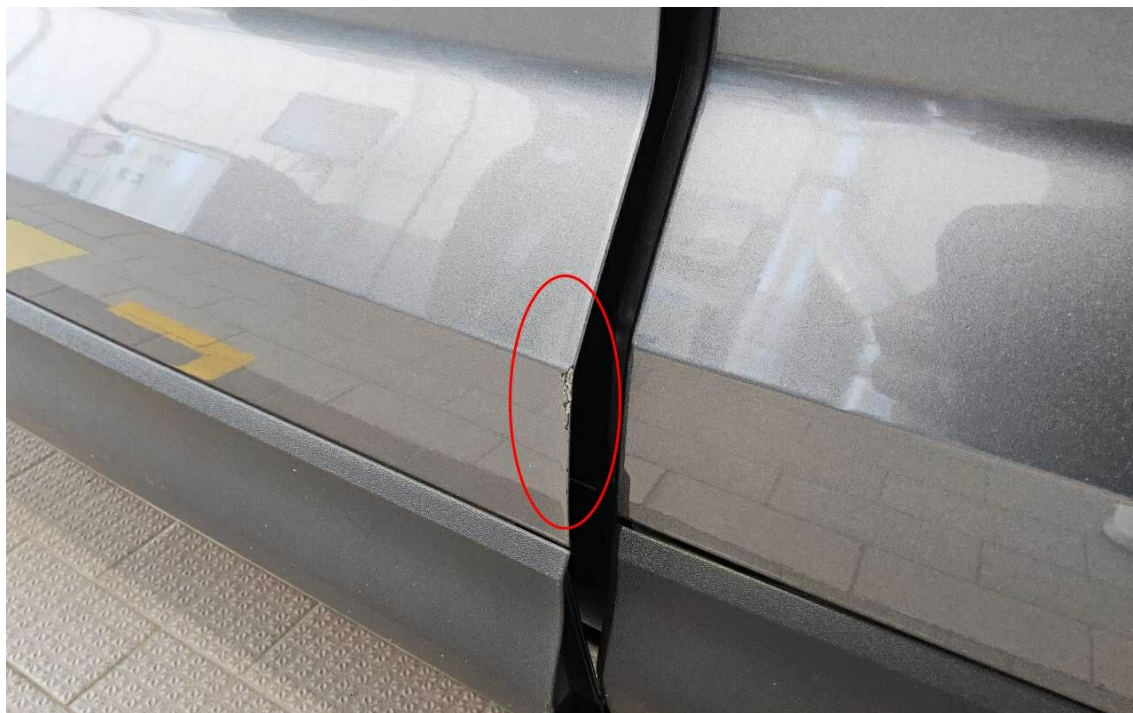
Bild 15 : Tür vorne links Türkante, Lackabplatzer, Gebrauchsspur
