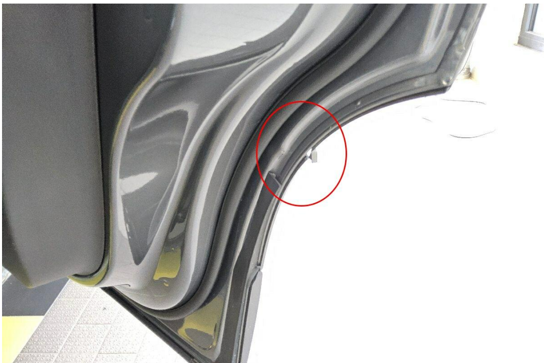
Bild 22 : Tür hinten rechts deformiert, Zierleiste beschädigt
