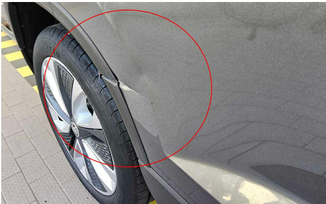
Bild 20 : Tür hinten rechts deformiert, Zierleiste beschädigt
