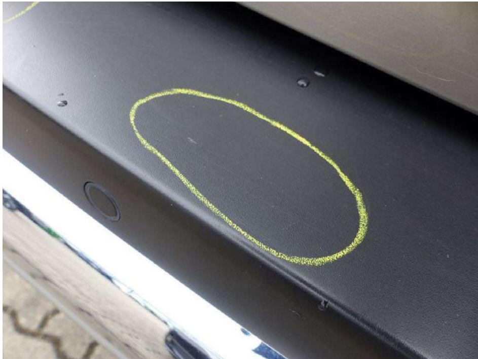
Bild 9 Stoßfängerverkleidung Kratzbeschädigung > 5cm
