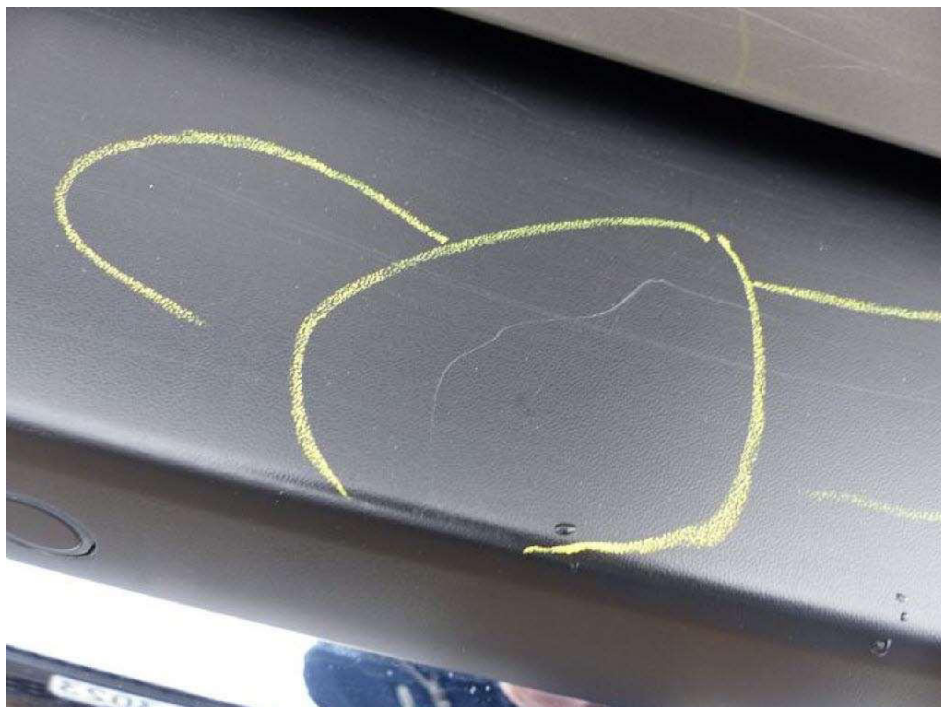
Bild 8 Stoßfängerverkleidung Kratzbeschädigung > 5cm
