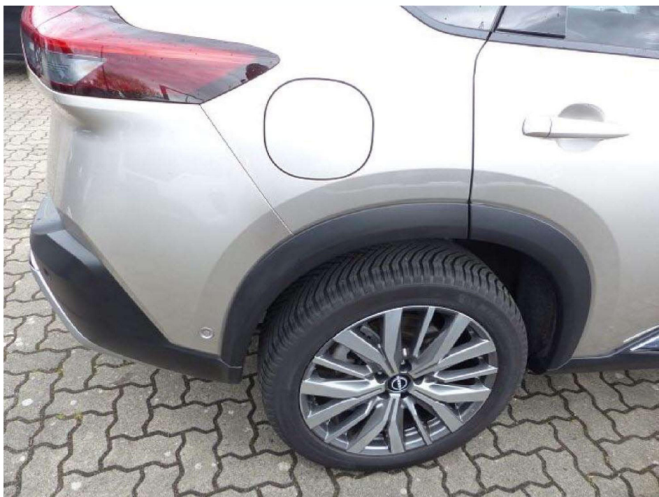
Bild 34 Gebrauchsspuren: Felge hinten rechts Kratzbeschädigung
