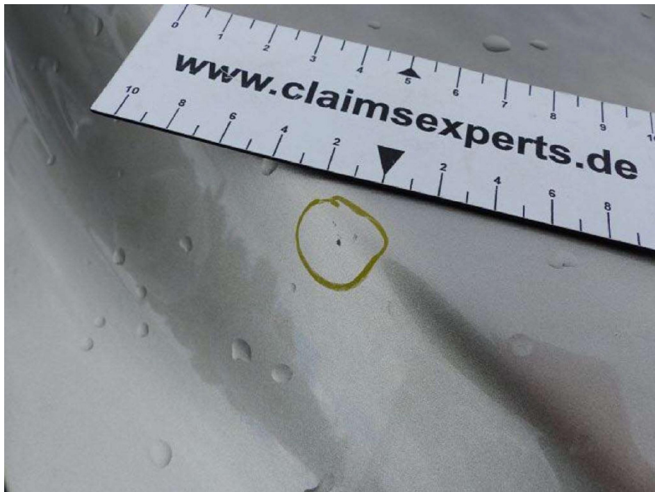
Bild 19 Motorhaube Steinschläge mit Lackablösung
