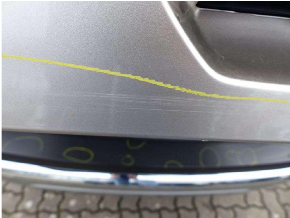
Bild 13 Heckklappe Kratzbeschädigung > 5cm
