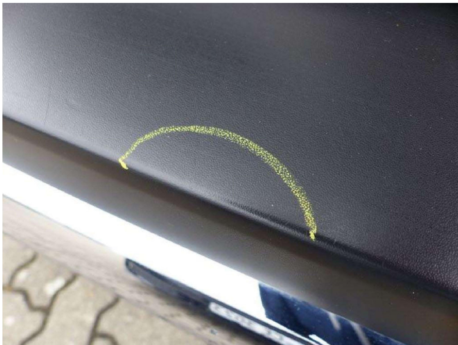
Bild 10 Stoßfängerverkleidung Kratzbeschädigung > 5cm
