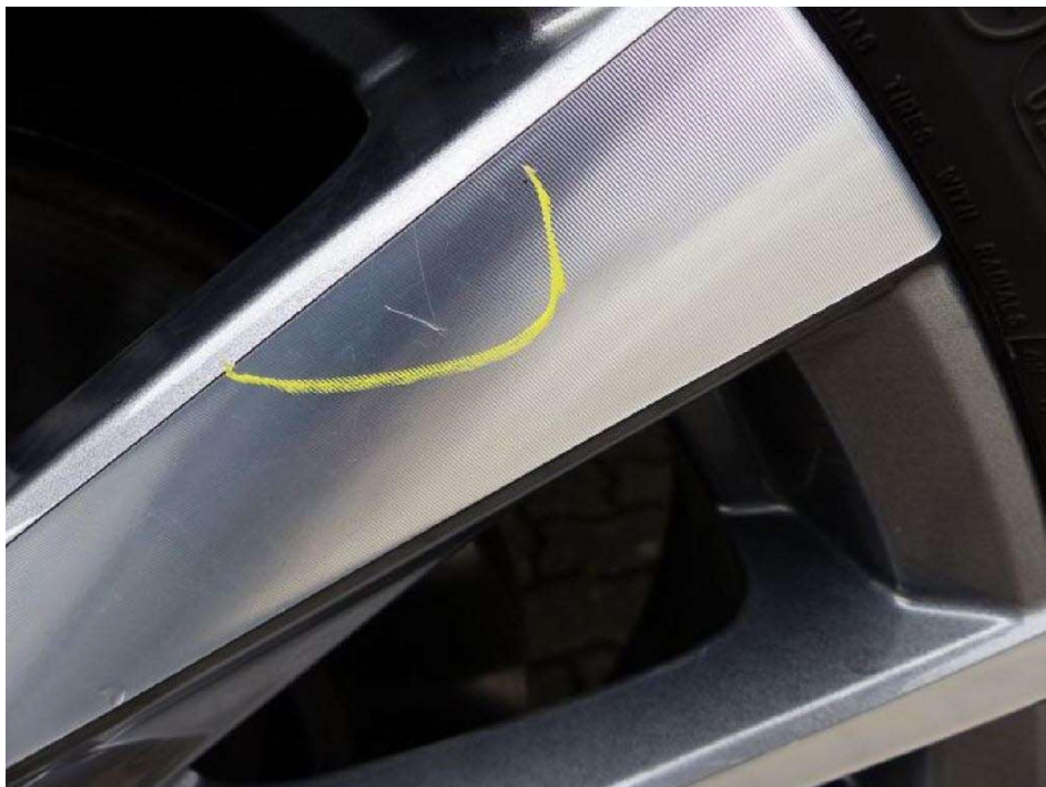
Bild 30 Gebrauchsspuren: Felge vorne links Kratzbeschädigung
