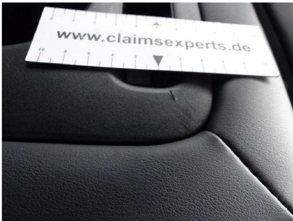
Bild 24 Armlehne hinten Kratzbeschädigung
