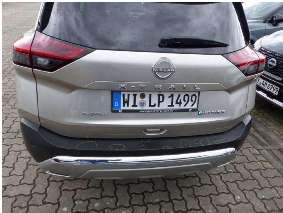
Bild 7 Stoßfängerverkleidung und Heckklappe Kratzbeschädigung > 5cm
