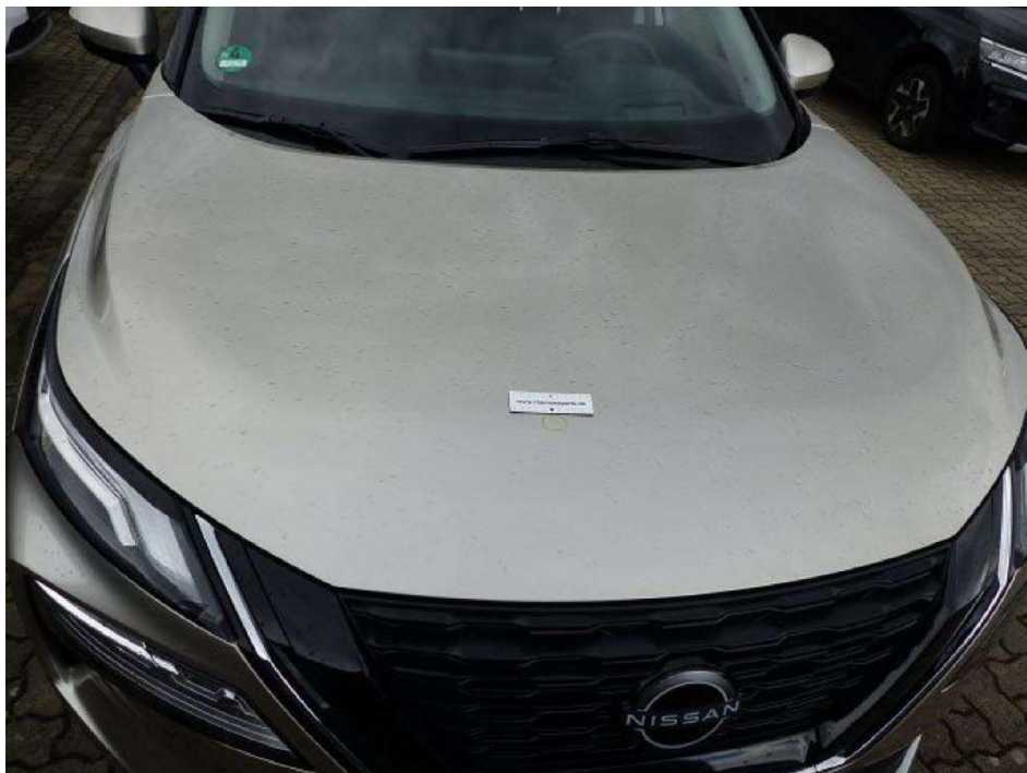
Bild 16 Motorhaube Steinschläge mit Lackablösung
