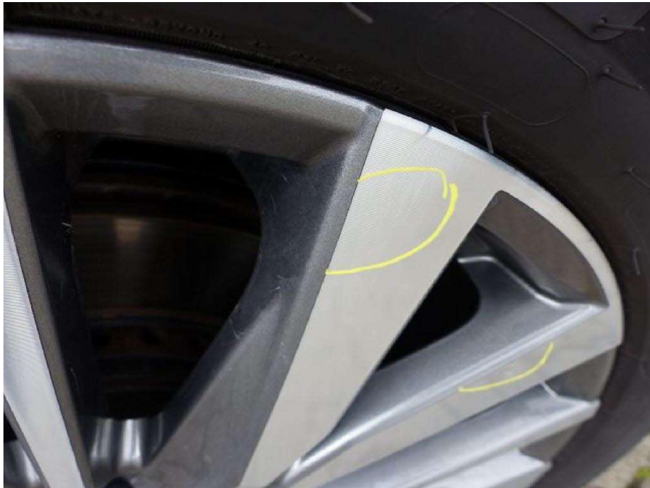
Bild 29 Gebrauchsspuren: Felge vorne links Kratzbeschädigung
