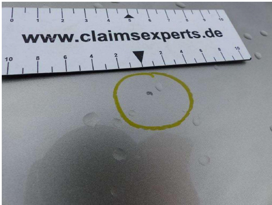
Bild 17 Motorhaube Steinschläge mit Lackablösung
