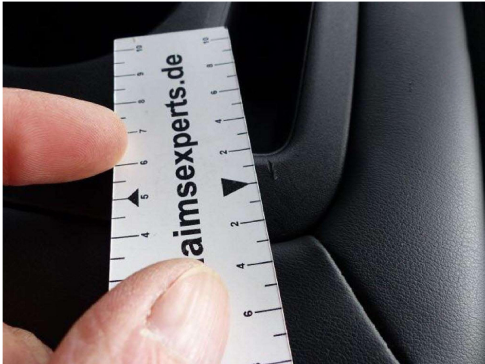
Bild 25 Armlehne hinten Kratzbeschädigung
