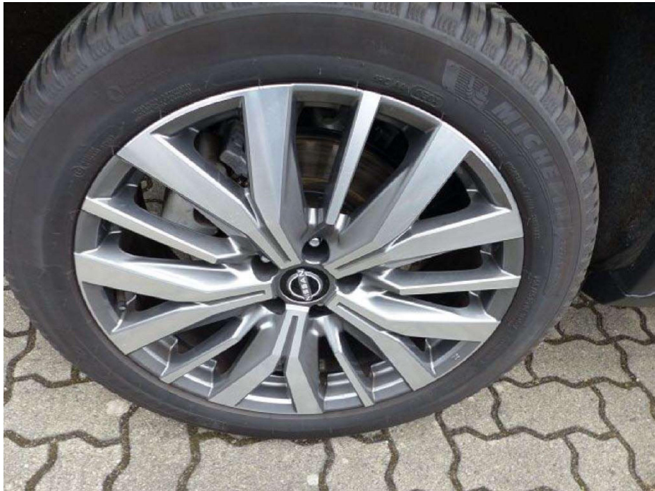
Bild 35 Gebrauchsspuren: Felge hinten rechts Kratzbeschädigung
