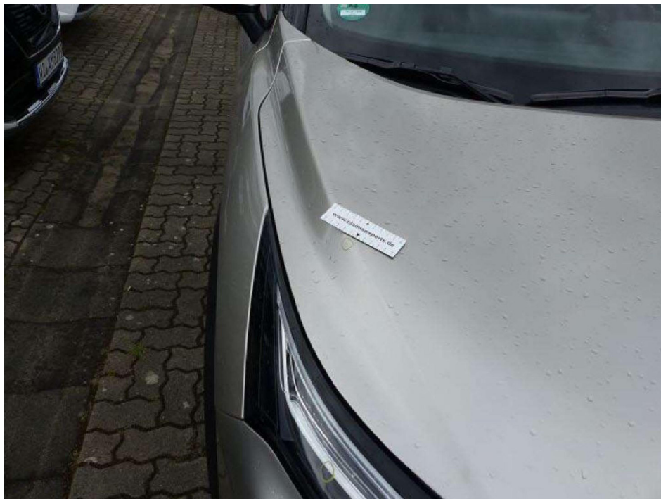
Bild 18 Motorhaube Steinschläge mit Lackablösung
