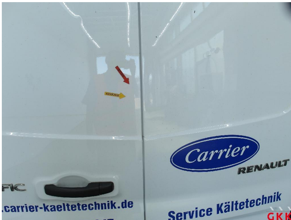
Bild 29. Hecktür links, beschädigt, instand setzen - lackieren
