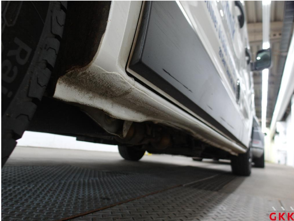
Bild 21. Schweller rechts, beschädigt, instand setzen - lackieren
