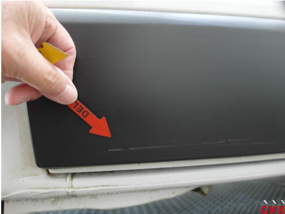
Bild 25. Schiebetür rechts, Leiste -unten-, verkratzt, ersetzen
