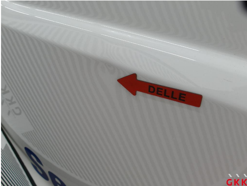
Bild 33. Seitenwand links, bis 3 Dellen / Bauteil, kalt drücken
