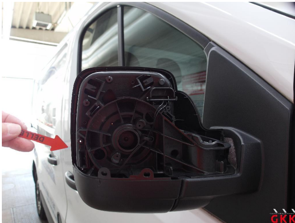
Bild 16. Spiegelgehäuse rechts, Kappe -unlackiert-, fehlt, ersetzen
