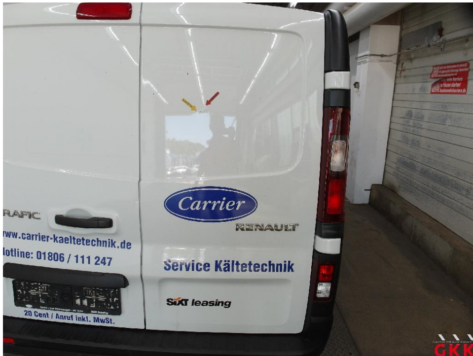
Bild 27. Hecktür rechts, beschädigt, instand setzen - lackieren
