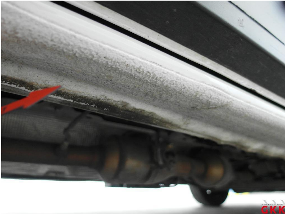
Bild 23. Schweller rechts, beschädigt, instand setzen - lackieren
