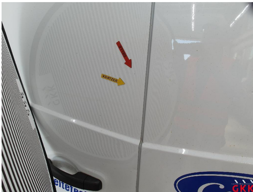
Bild 30. Hecktür links, beschädigt, instand setzen - lackieren
