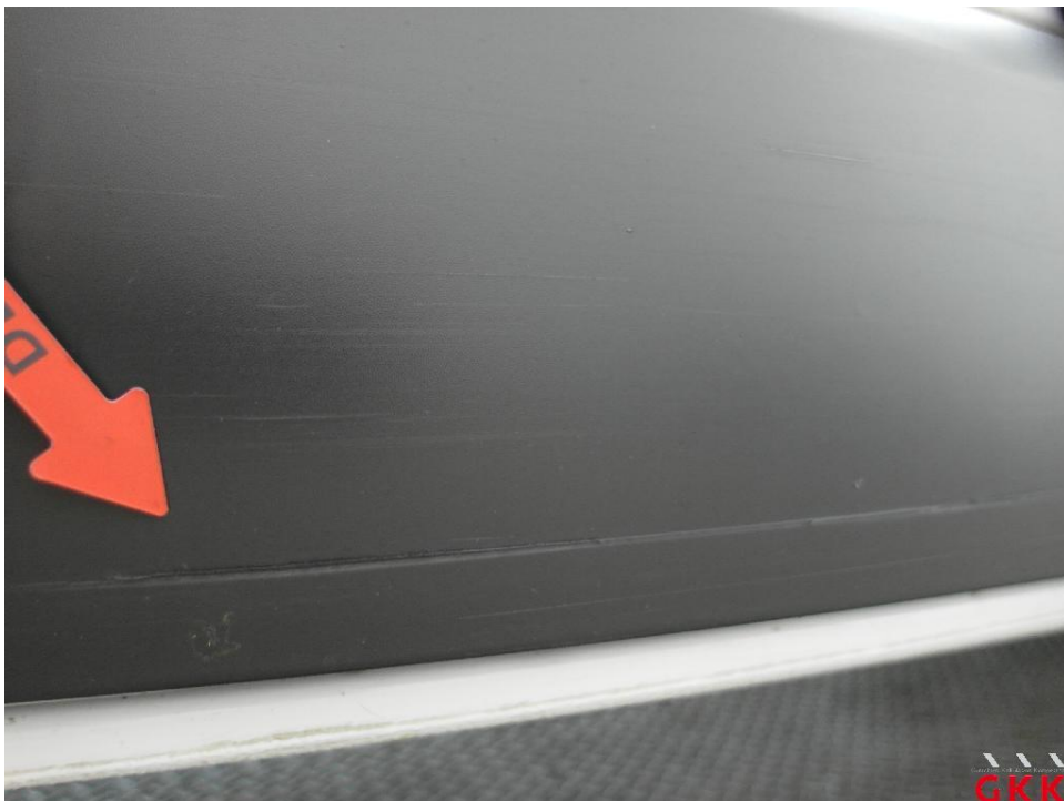
Bild 26. Schiebetür rechts, Leiste -unten-, verkratzt, ersetzen
