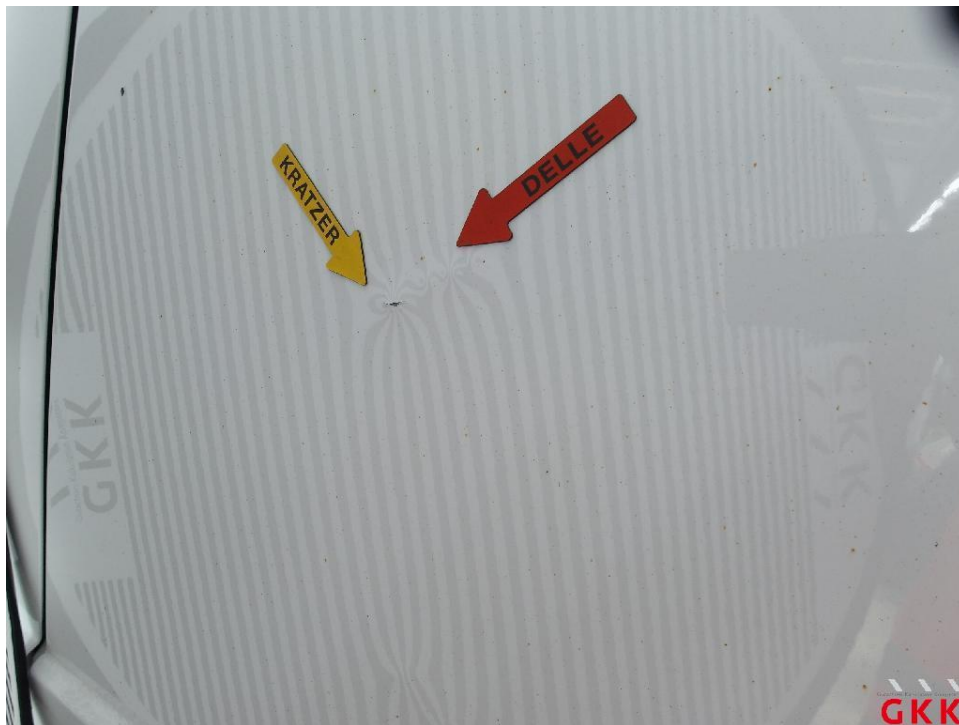
Bild 28. Hecktür rechts, beschädigt, instand setzen - lackieren
