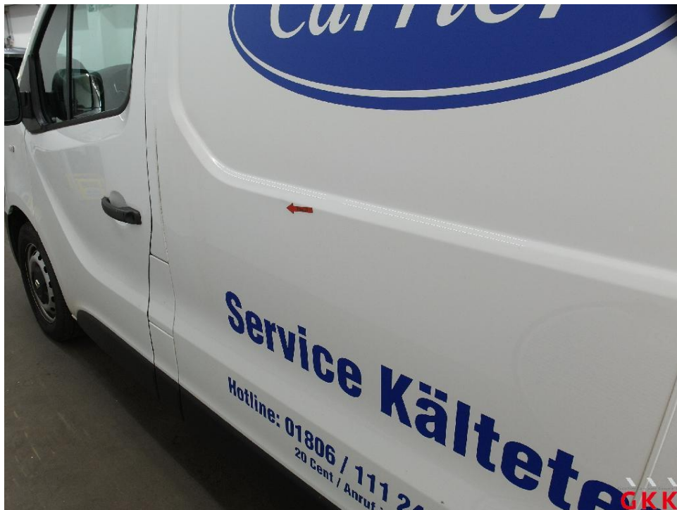
Bild 32. Seitenwand links, bis 3 Dellen / Bauteil, kalt drücken
