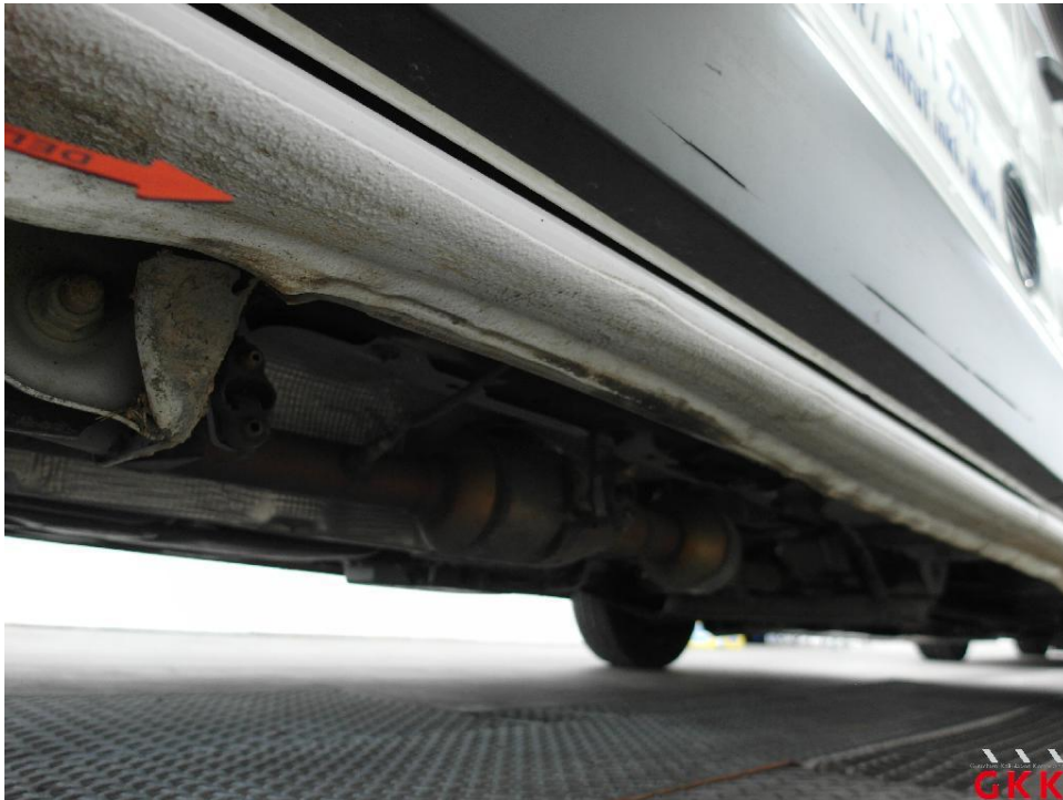
Bild 22. Schweller rechts, beschädigt, instand setzen - lackieren
