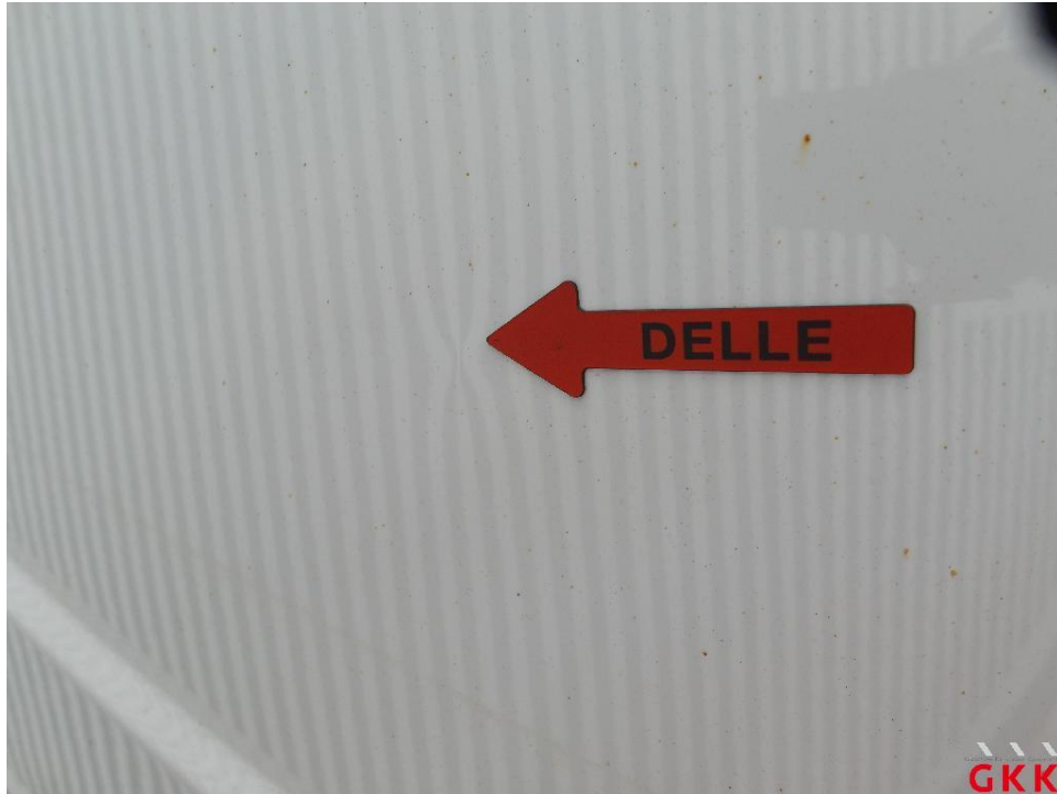
Bild 31. Hecktür links, beschädigt, instand setzen - lackieren
