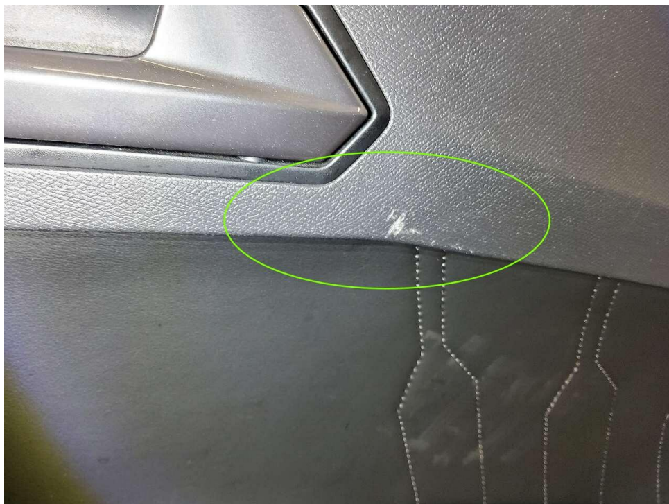
Bild 18 : Türverkleidung hinten rechts mehrfach verschrammt
