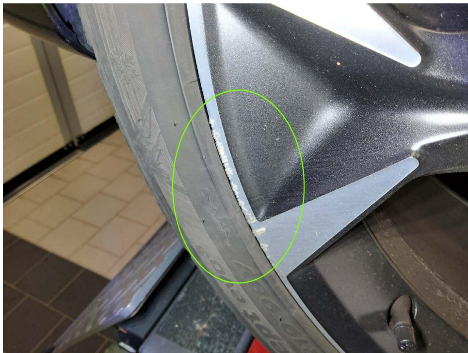
Bild 23 : Leichtmetallfelge glanzgedreht vorne links mehrfach verschrammt
