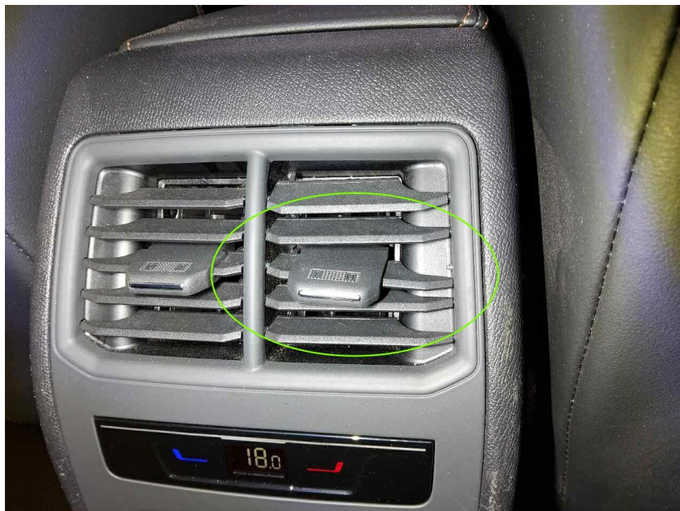
Bild 14 : Mittelkonsole hinten, Luftdüse rechts gebrochen
