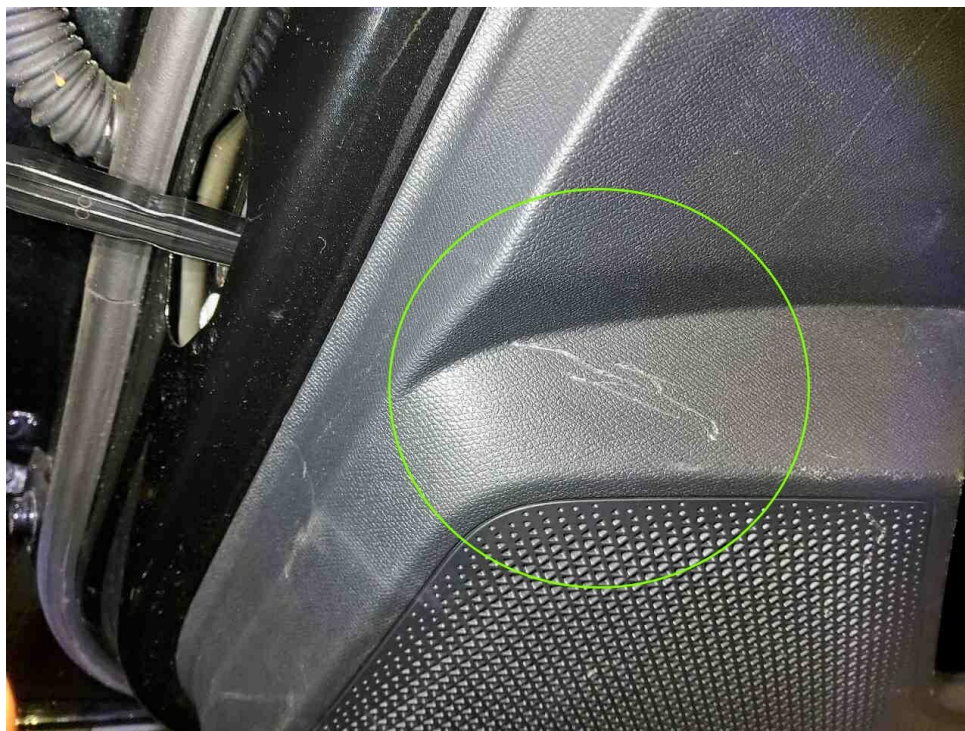
Bild 20 : Türverkleidung hinten rechts mehrfach verschrammt
