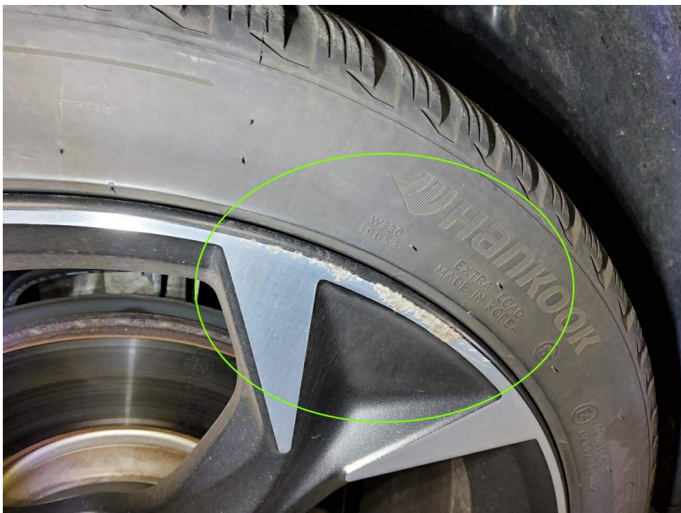
Bild 22 : Leichtmetallfelge glanzgedreht vorne links mehrfach verschrammt
