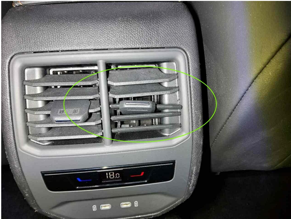
Bild 15 : Mittelkonsole hinten, Luftdüse rechts gebrochen
