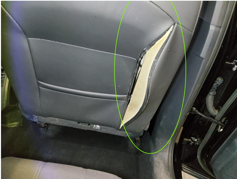
Bild 21 : Beifahrersitz, Rückenlehne Bezug beschädigt
