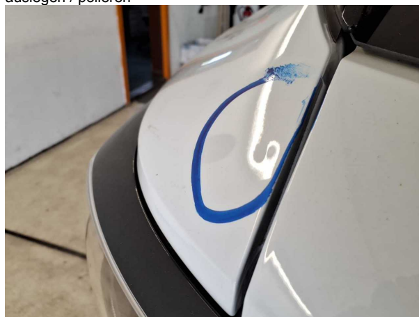
Beschädigung #3: Seitenwand links: Seitenwand - Delle(n) - sanft instandsetzen
