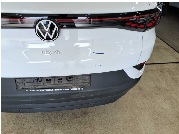
Beschädigung #2: Heckklappe/-tür: Heckklappe - Kratzer - auslegen / polieren
