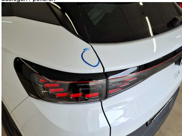
Beschädigung #3: Seitenwand links: Seitenwand - Delle(n) - sanft instandsetzen
