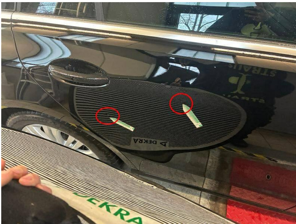
Bild 20 : Tür hinten rechts, eingedellt, drücken
