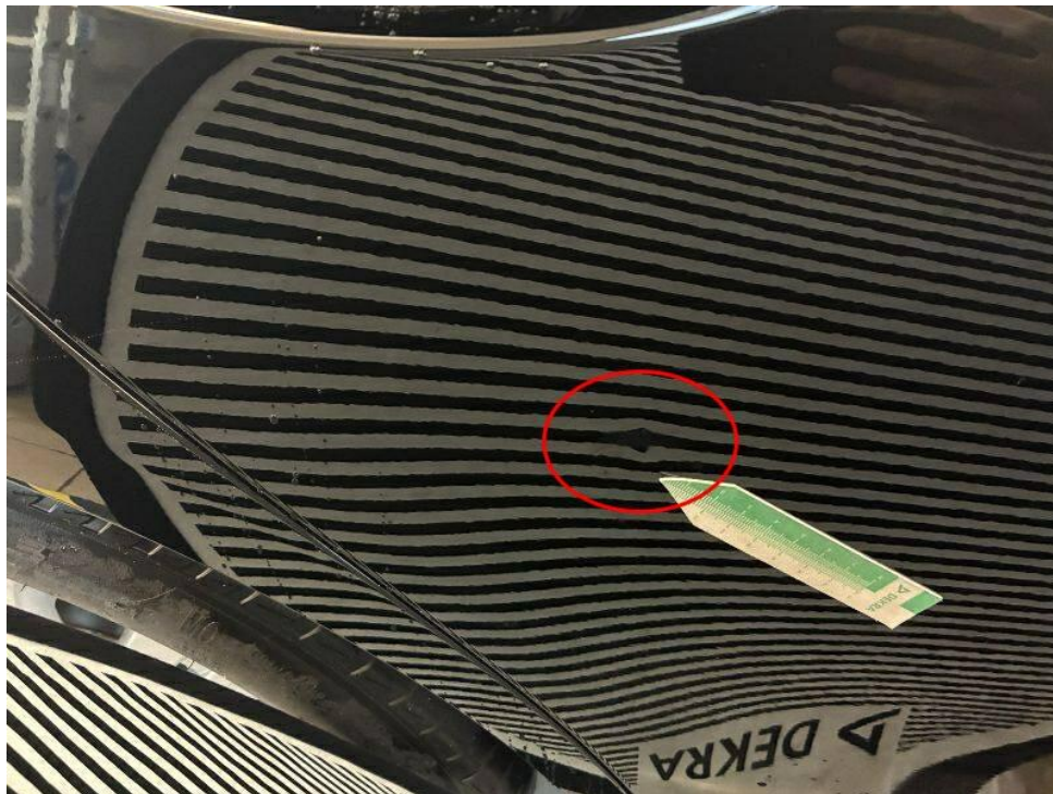
Bild 21 : Tür hinten rechts, eingedellt, drücken
