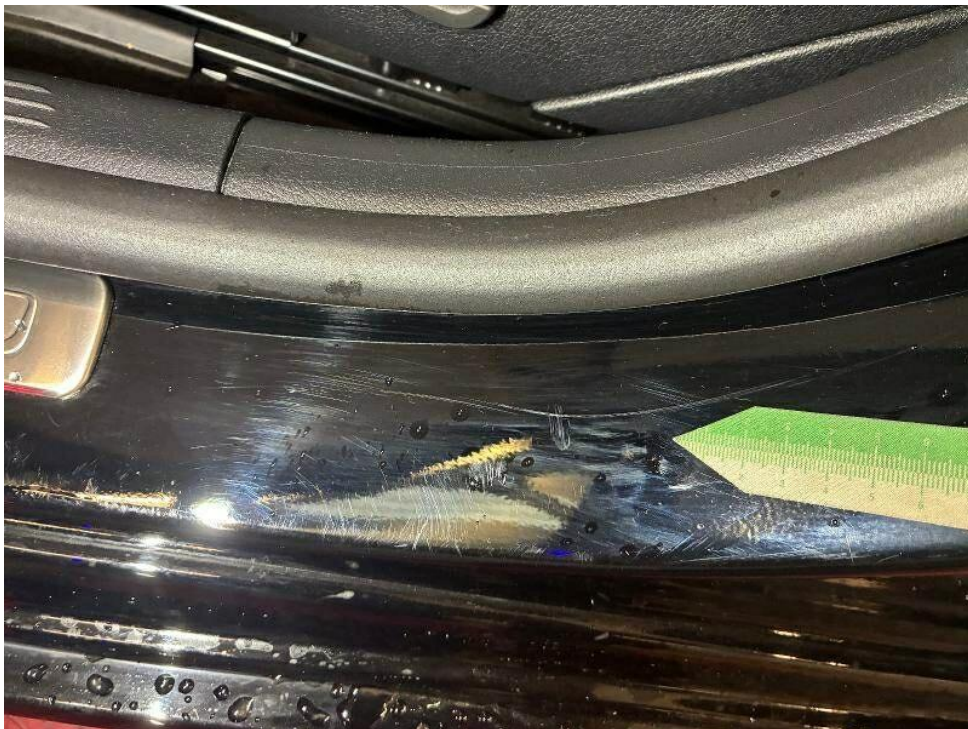
Bild 16 : Tür vorne rechts Einstieg Lackierung, zerkratzt, Gebrauchsspur
