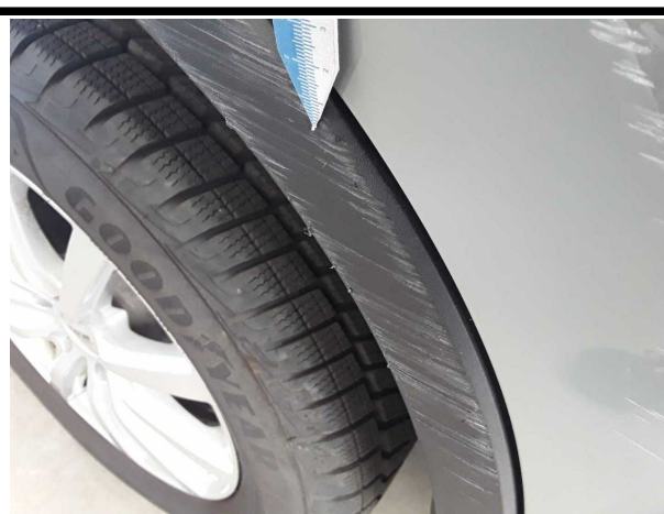
Beschädigung #4: Seitenwand rechts: Radhausverbreiterun... verkratzt / verschürft - erneuern
