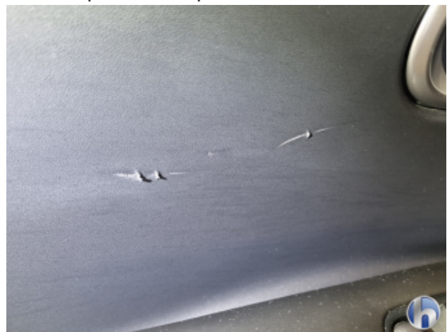
4. Türverkleidung Hinten - Links Loch - Erneuern
