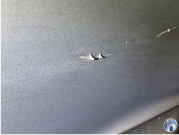
4. Türverkleidung Hinten - Links Loch - Erneuern
