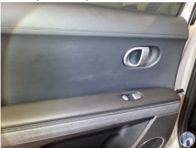
4. Türverkleidung Hinten - Links Loch - Erneuern
