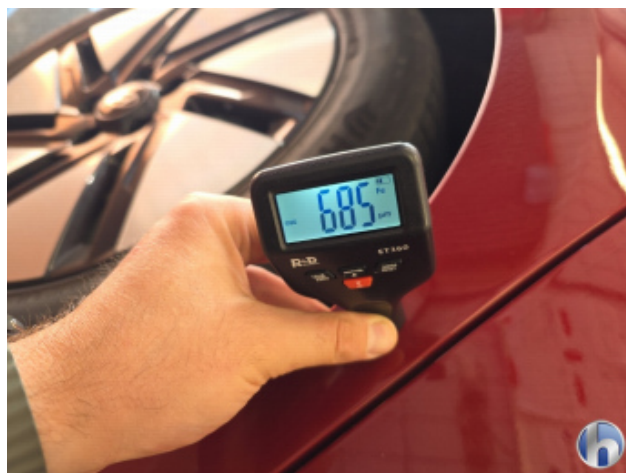
1. Seitenwand - Hinten - Rechts Nachlackiert - Ohne Reparatur
