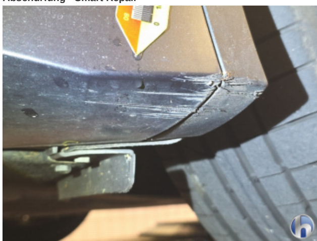
7. Frontspoiler Abschürfung - Smart Repair
