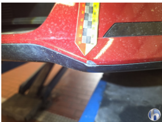
7. Frontspoiler Abschürfung - Smart Repair
