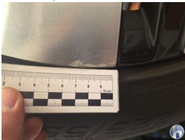
6. Felge Vorne - Rechts Kratzer - Smart Repair
