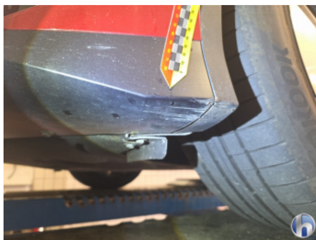
7. Frontspoiler Abschürfung - Smart Repair
