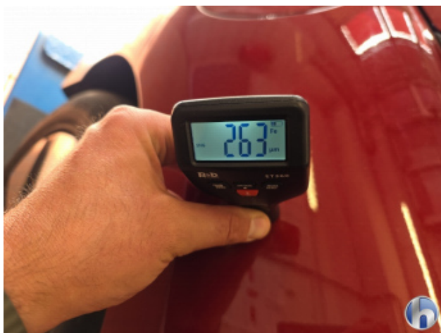
1. Seitenwand - Hinten - Rechts Nachlackiert - Ohne Reparatur
