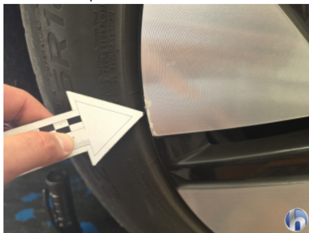
6. Felge Vorne - Rechts Kratzer - Smart Repair
