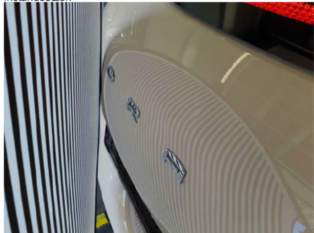
Beschädigung #2: Heckklappe/-tür: Heckklappe - Delle(n) - sanft instandsetzen
