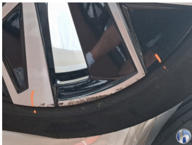
2. 2. Radsatz Beschädigt - Smart Repair
