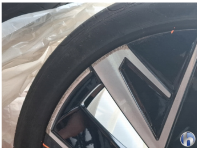
2. 2. Radsatz Beschädigt - Smart Repair
