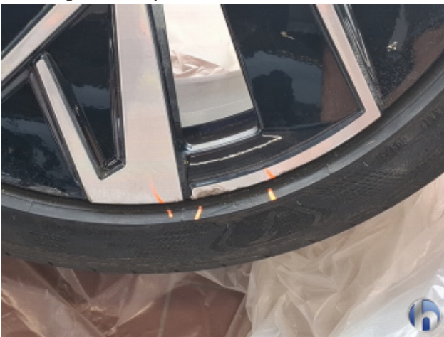
2. 2. Radsatz Beschädigt - Smart Repair
