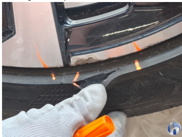
2. 2. Radsatz Beschädigt - Smart Repair
