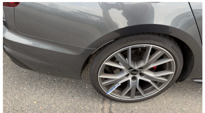
Damage 8: Wheel / tyres: Tyre - rear right side (Flankenbeschädigung) - Damaged - Replace
