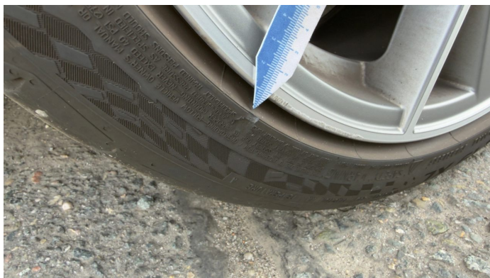
Damage 8: Wheel / tyres: Tyre - rear right side (Flankenbeschädigung) - Damaged - Replace
