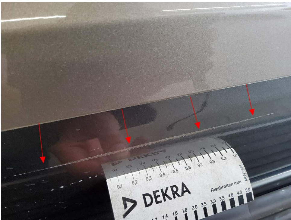
Bild 15 : Schiebetüre links, Folierung beschädigt
