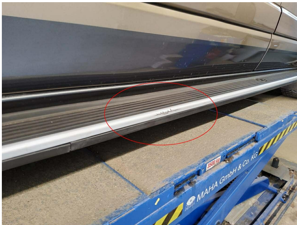
Bild 18 : Trittstufe rechts, verschrammt
