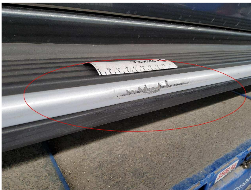
Bild 19 : Trittstufe rechts, verschrammt
