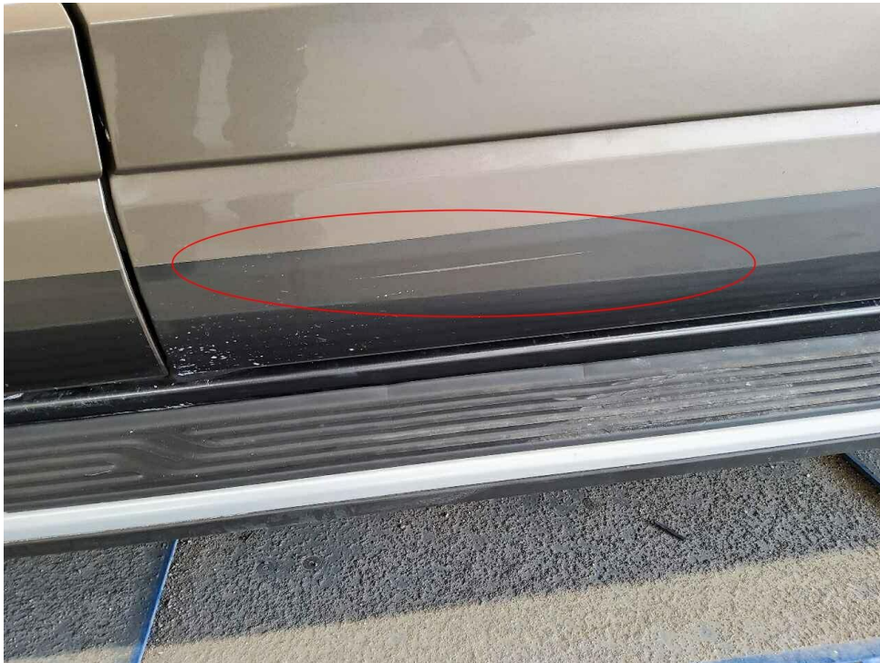
Bild 14 : Schiebetüre links, Folierung beschädigt
