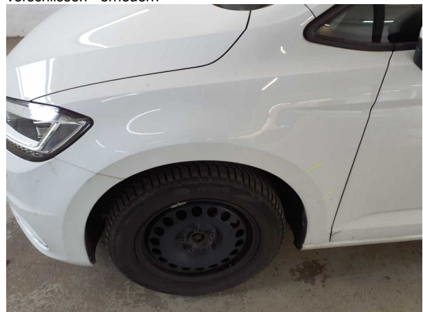
Beschädigung #9: Kotflügel links: Kotflügel links - Delle(n) - instandsetzen und lackieren
