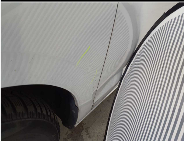
Beschädigung #9: Kotflügel links: Kotflügel links - Delle(n) - instandsetzen und lackieren
