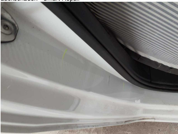
Beschädigung #5: Seitenwand rechts: Einstieg - Delle / Lackschaden - Smart Repair
