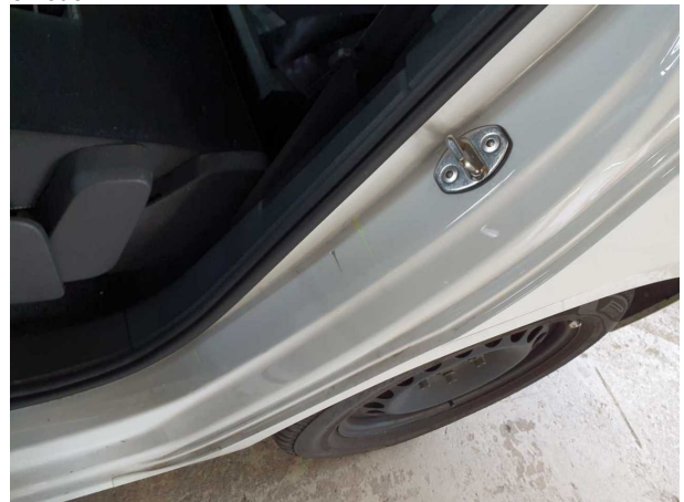
Beschädigung #4: Seitenwand links: Einstieg - Delle / Lackschaden - Smart Repair
