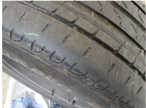
Beschädigung #7: 2.Radsatz: 2 Reifen (Einseitig abgefahre... verschlissen - erneuern
