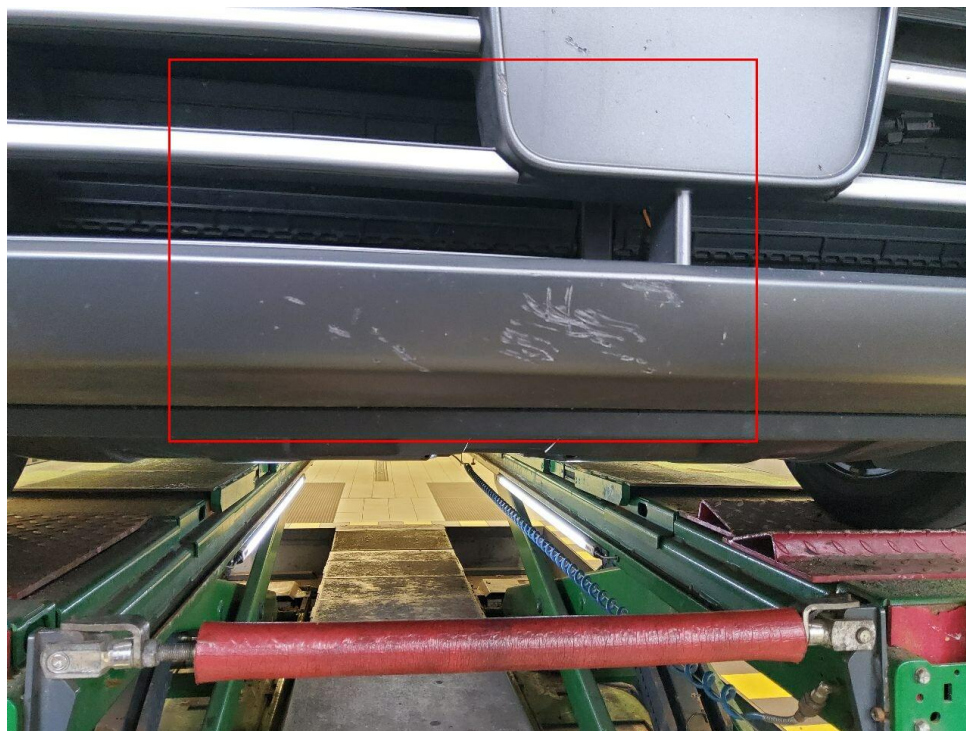
Bild 10 : Stoßfänger vorn, Unterteil eingekerbt und verformt
