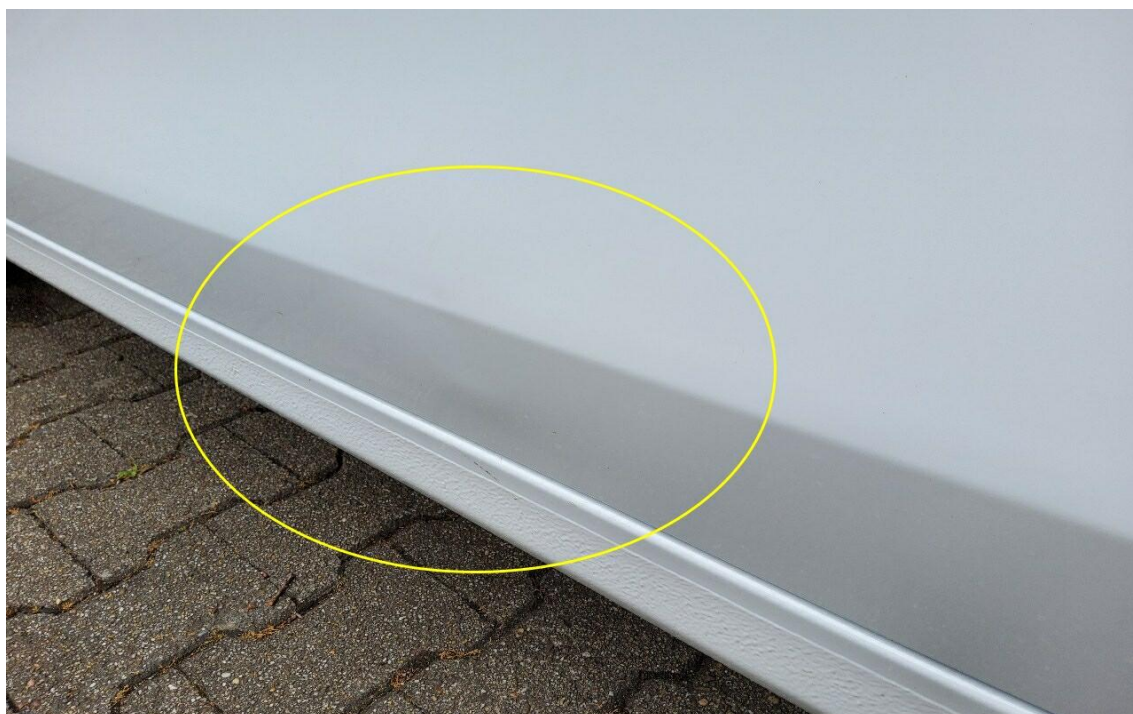
Bild 22 : Tür vorne links, eingedellt, drücken
