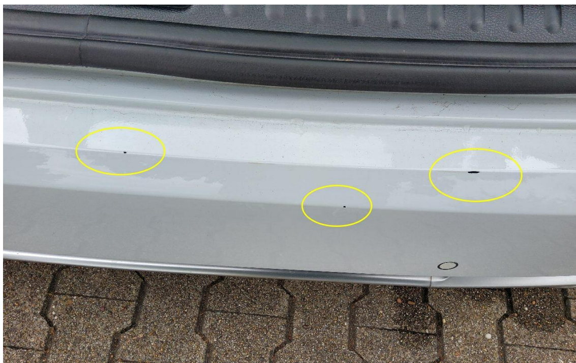
Bild 24 : Stoßfänger hinten Lackierung, zerkratzt, smart repair
