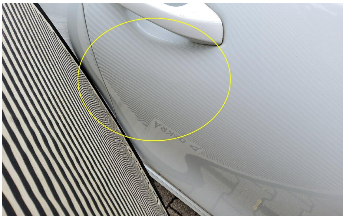
Bild 26 : Tür vorne rechts, eingedellt, drücken
