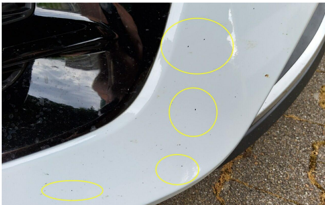
Bild 20 : Frontspoiler Lackierung, Steinschlag, lackieren mit Lackaufbau
