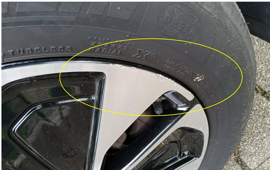
Bild 31 : Glanzgedrehte Alufelge vorne rechts, verschrammt
