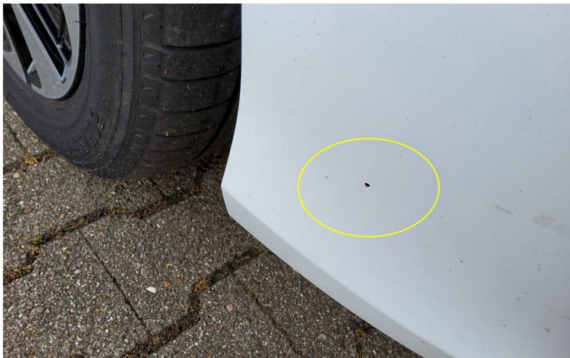
Bild 19 : Frontspoiler Lackierung, Steinschlag, lackieren mit Lackaufbau
