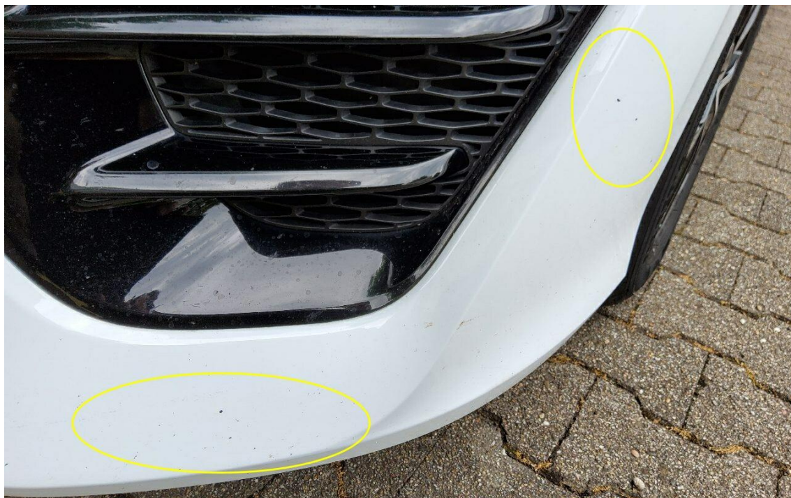
Bild 21 : Frontspoiler Lackierung, Steinschlag, lackieren mit Lackaufbau
