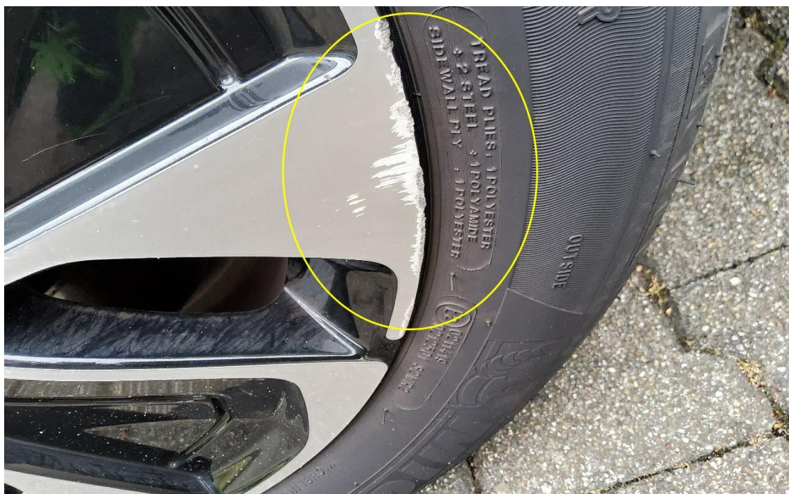
Bild 28 : Glanzgedrehte Alufelge vorne links, verschrammt
