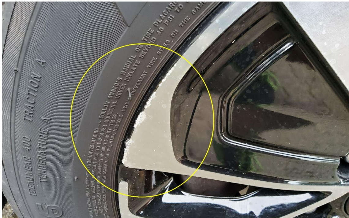
Bild 27 : Glanzgedrehte Alufelge vorne links, verschrammt
