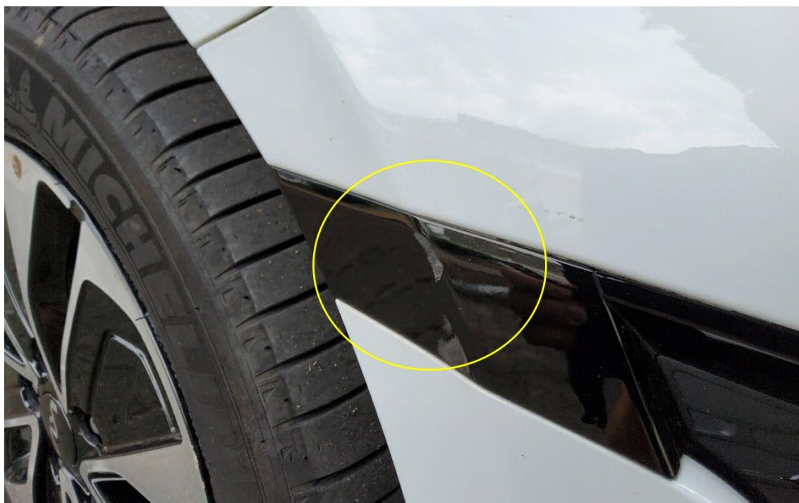
Bild 18 : Stossfänger vorne rechts Blende zerkratzt,
