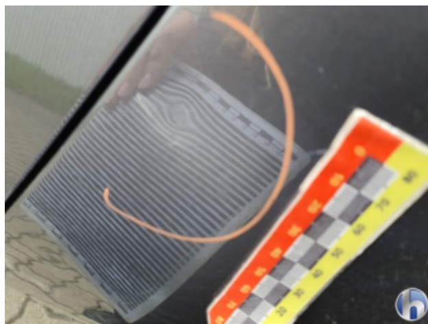
7. Seitenwand - Hinten - Links Gebrauchsspuren - Ohne Reparatur
