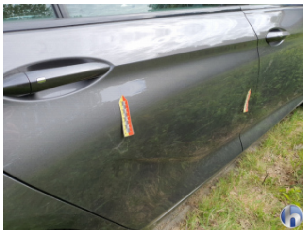
5. Tür Hinten - Rechts Kratzer - Smart Repair
