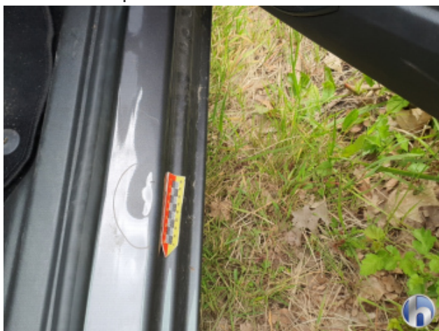
1. Türeinstieg Vorne - Rechts 1 Delle - Smart Repair
