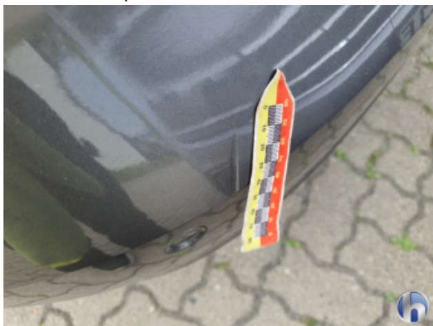
4. Stoßfänger Hinten Kratzer Tief Bis Grundierung - Smart Repair
