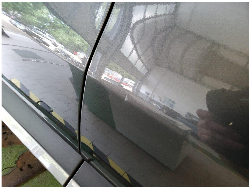
Bild 10 : Tür vorne rechts Delle
