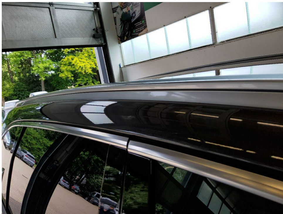
Bild 13 : Dachrahmen rechts Delle
