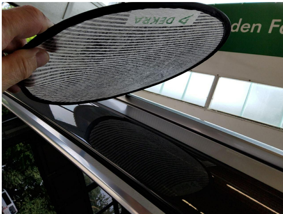
Bild 14 : Dachrahmen rechts Delle
