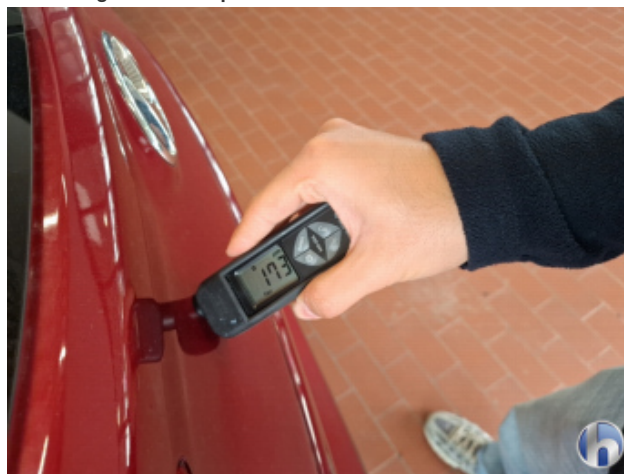
3. Heckklappe Nachlackiert - Ohne Reparatur
