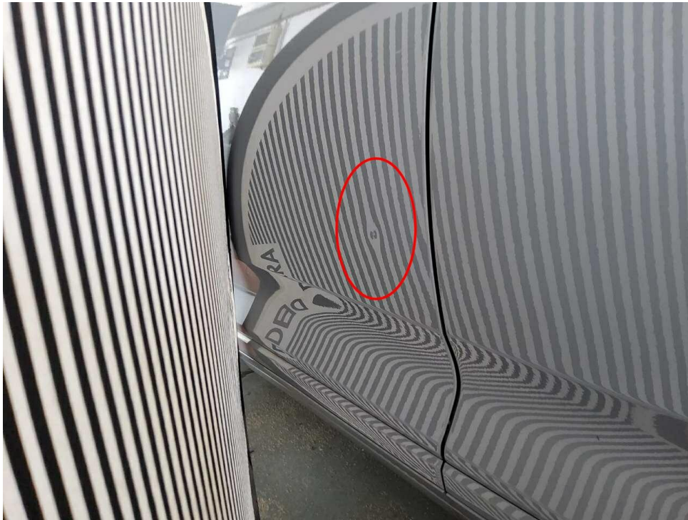
Bild 15 : Tür vorne links, eingedellt, drücken
