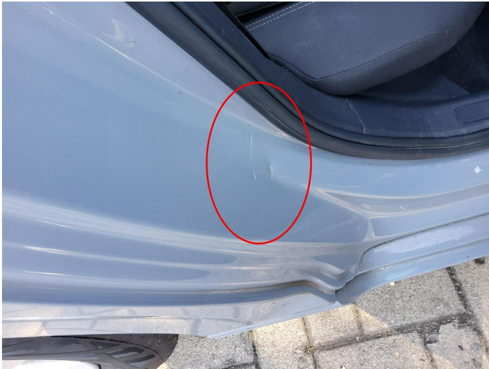
Bild 19 : Tür hinten rechts Einstieg, eingedellt, smart repair
