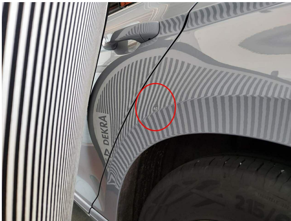
Bild 14 : Seitenteil hinten links, eingedellt, drücken
