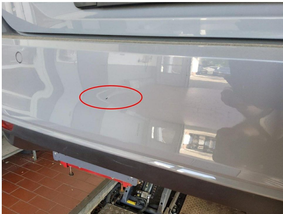
Bild 17 : Stoßfänger hinten Lackierung, zerkratzt, lackieren mit Lackaufbau
