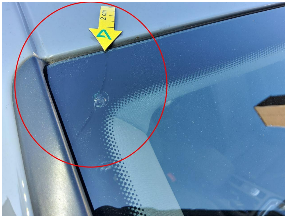
Bild 22 : Windschutzscheibe Steinschlag mit Rissbildung
