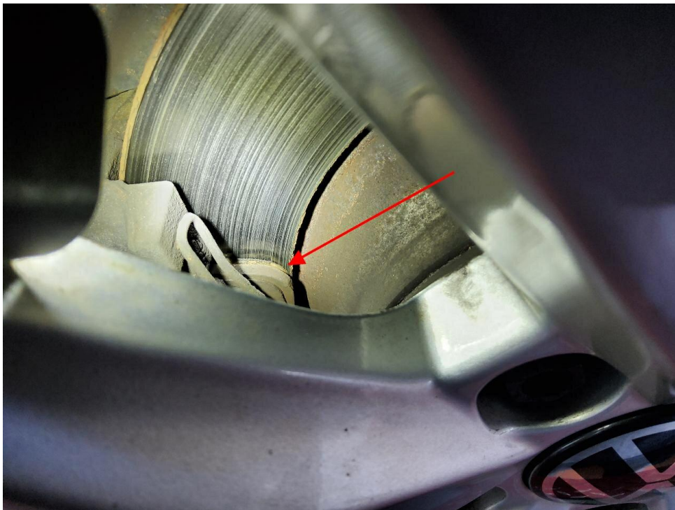
Bild 20 : Bremsbeläge hinten verschlissen
