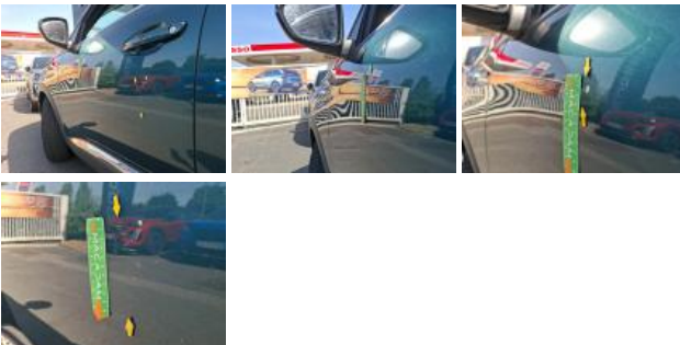
Door trim FL, Scratch(es), Replace
