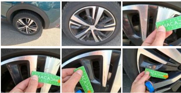
Alloy rim RR bitone/polychrome, Scratch(es), Repair/replace (lump sum)
