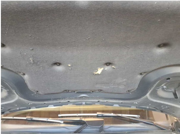
Beschädigung #2: Motorhaube: Dämmmatte - Marderschaden - erneuern
