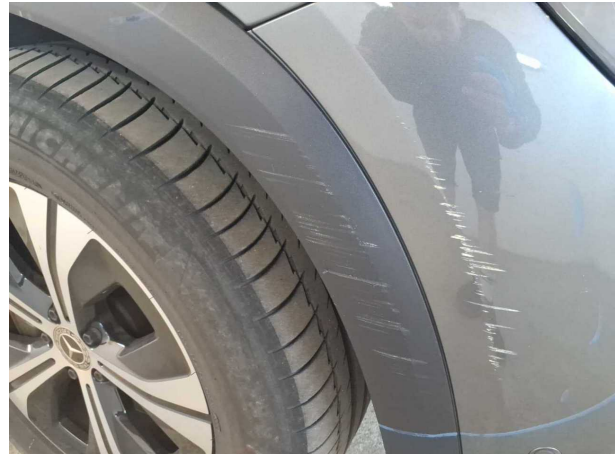
Beschädigung #3: Kotflügel rechts: Radhausverbreiterung - verkratzt / verschürft - erneuern
