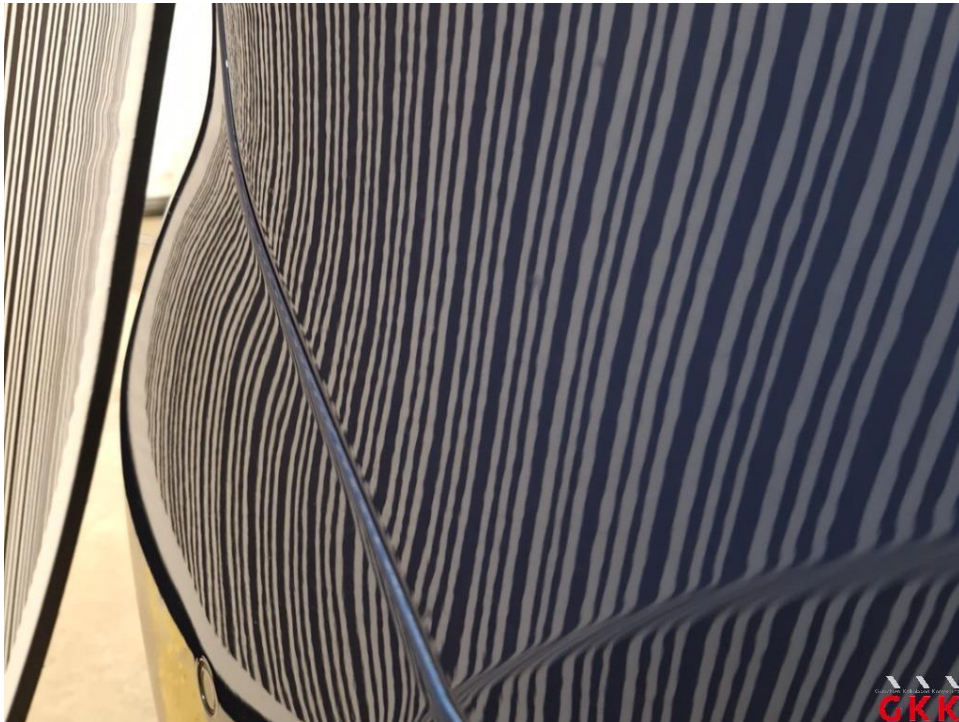
Bild 19 Seitenwand rechts, Reparaturmangel, aufbereiten
