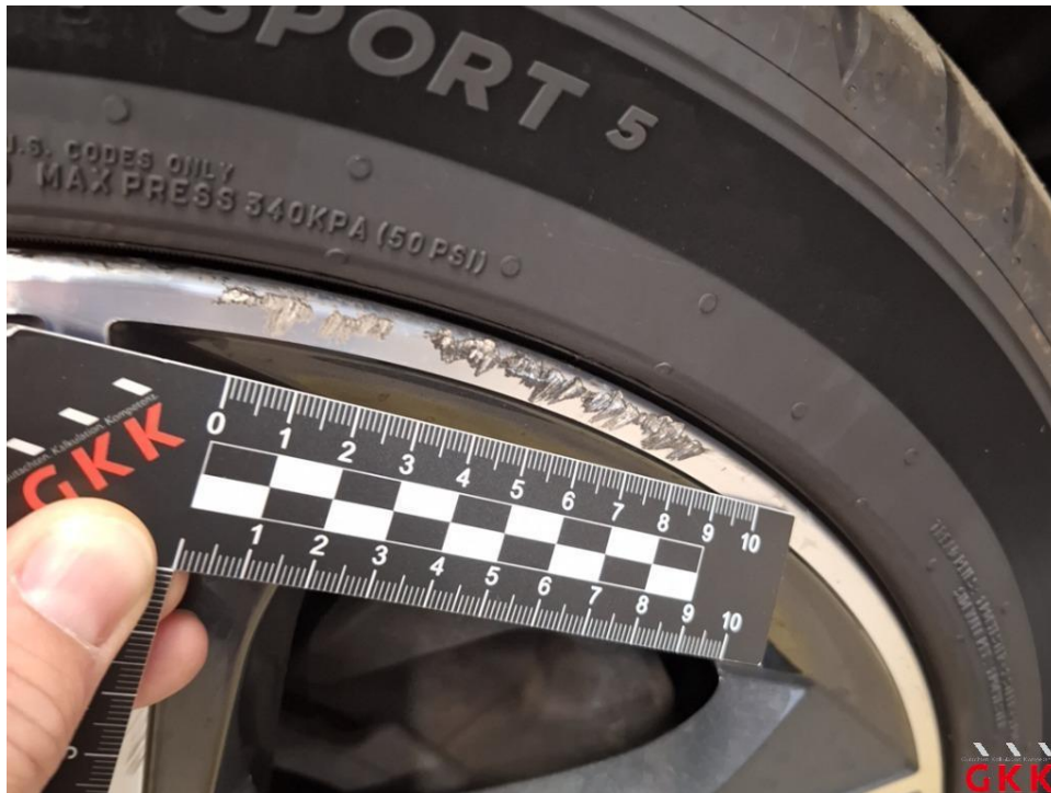
Bild 15 LM-Rad, vorne rechts, verkratzt, ersetzen
