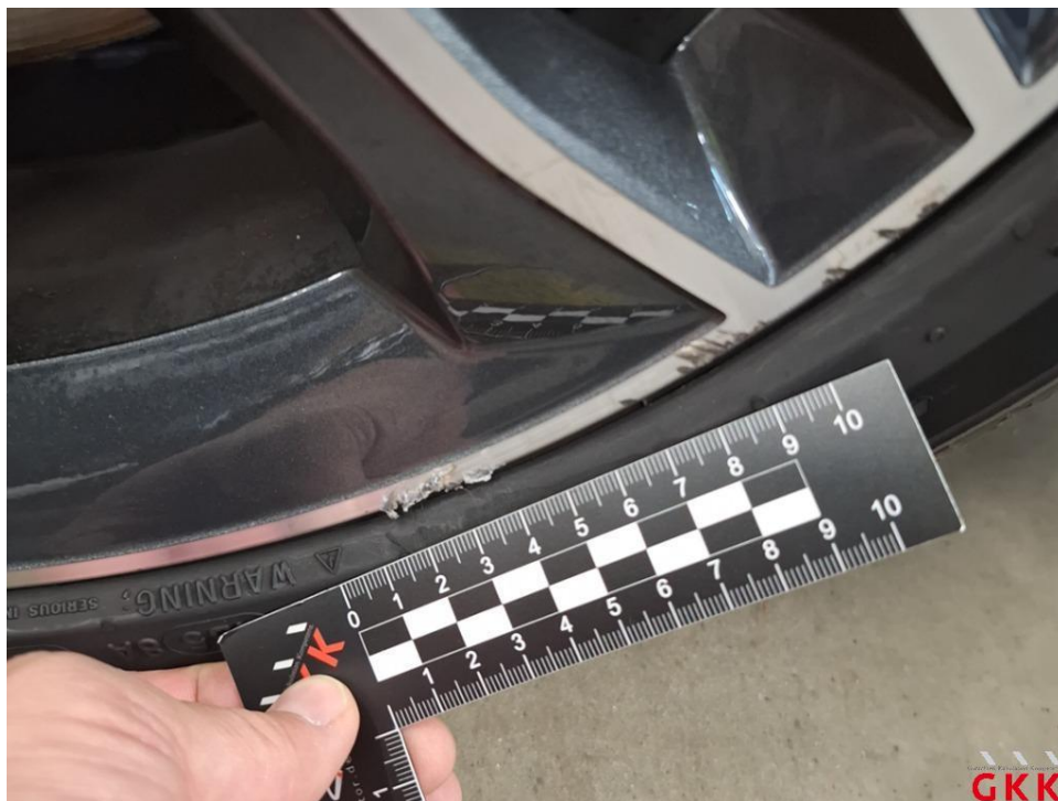
Bild 16 LM-Rad, vorne rechts, verkratzt, ersetzen
