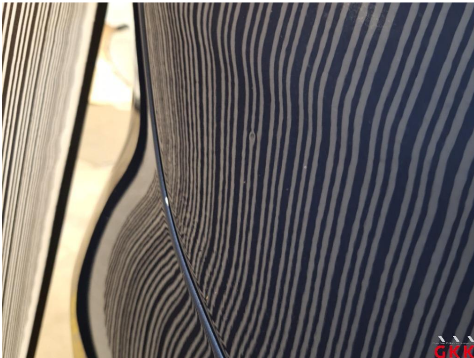
Bild 18 Seitenwand rechts, Reparaturmangel, aufbereiten
