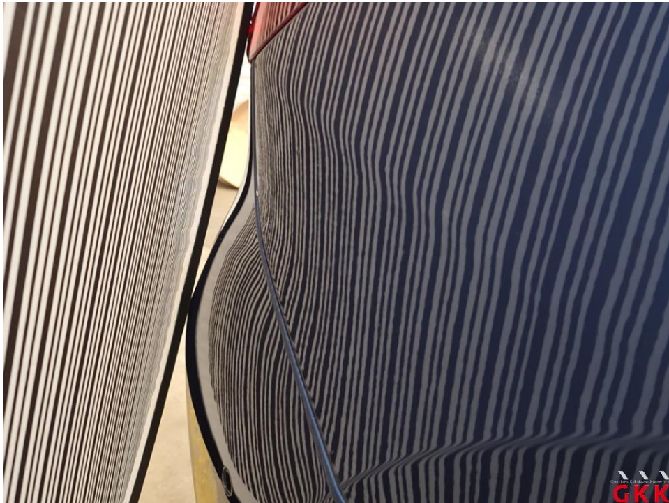
Bild 17 Seitenwand rechts, Reparaturmangel, aufbereiten
