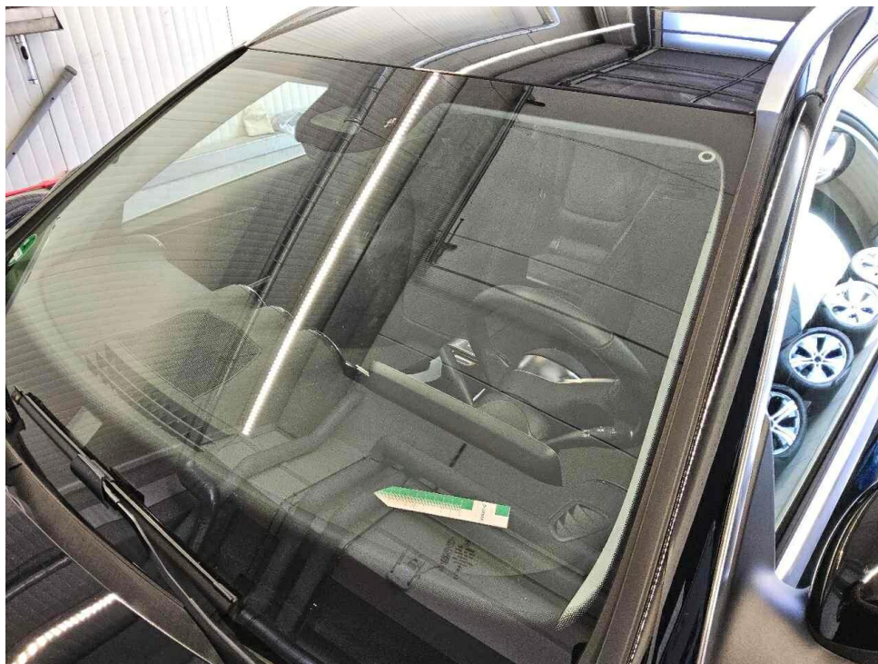
Bild 16 : Frontscheibe, mehrere leichte Abplatzungen
