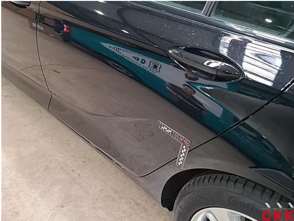
Bild 32. Tür hinten links, beschädigt, instand setzen - lackieren
