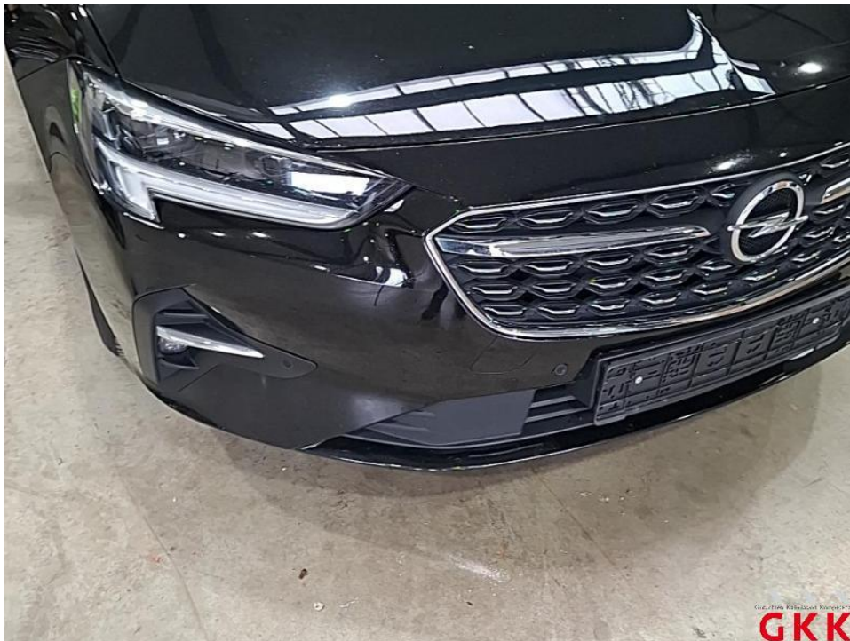
Bild 21. Stoßfänger vorne, Verkleidung -lackiert-, Steinschlag und Kratzer, lackieren
