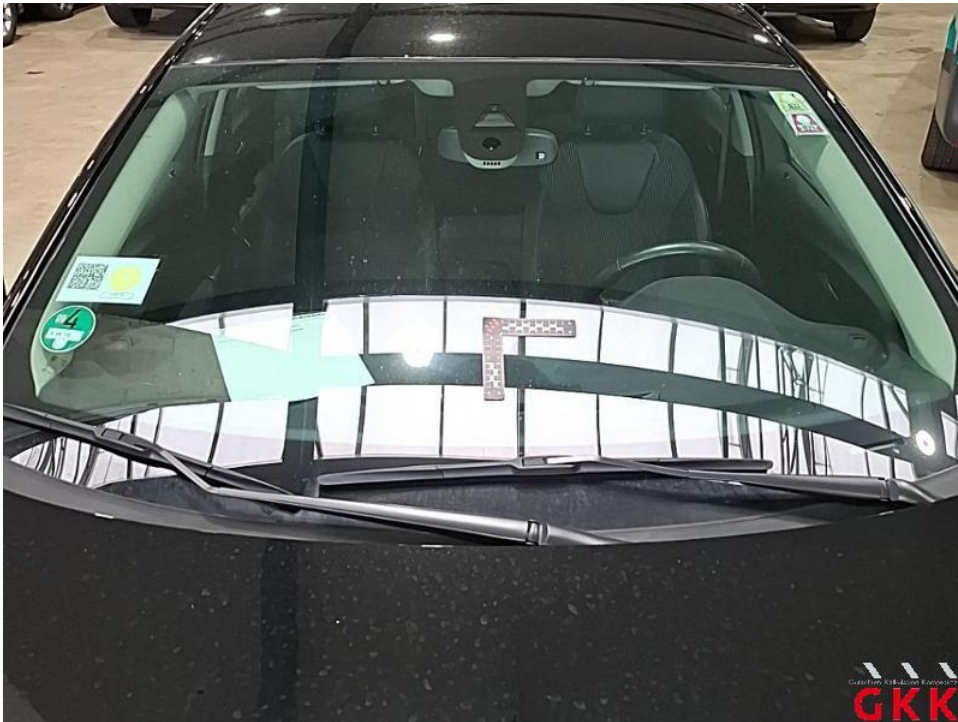
Bild 16. Frontscheibe, mit Regensensor und Frontkamera, Steinschlag mit Rissbildung, ersetzen
