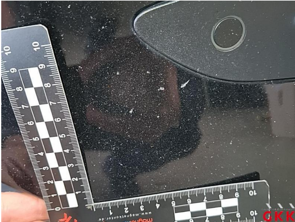
Bild 23. Stoßfänger vorne, Verkleidung -lackiert-, Steinschlag und Kratzer, lackieren
