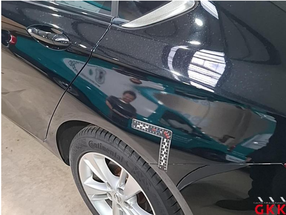
Bild 35. Seitenwand links, Reparaturmangel, Smartrepair
