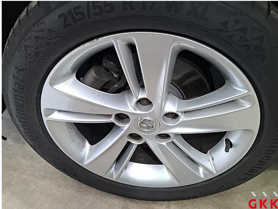
Bild 26. LM-Rad, vorne links, Materialabtrag, ersetzen
