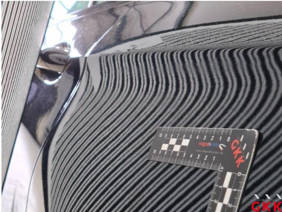
Bild 37. Seitenwand links, Reparaturmangel, Smartrepair
