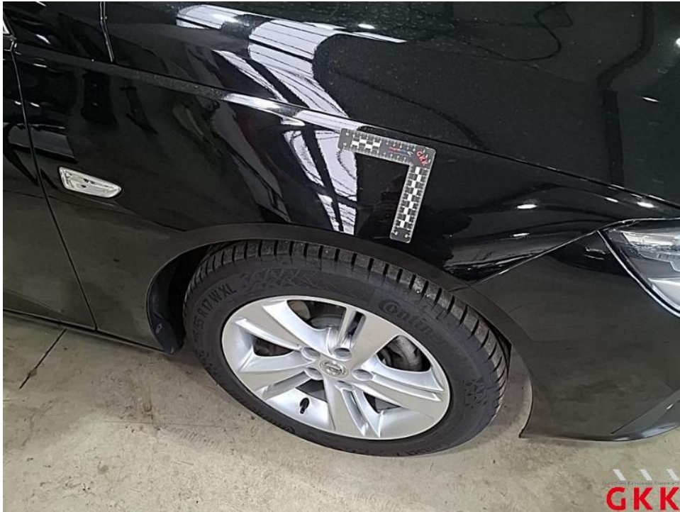
Bild 13. Kotflügel vorne rechts, Steinschlag und Kratzer, lackieren
