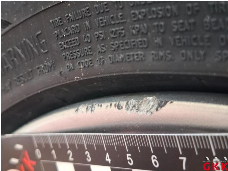
Bild 27. LM-Rad, vorne links, Materialabtrag, ersetzen
