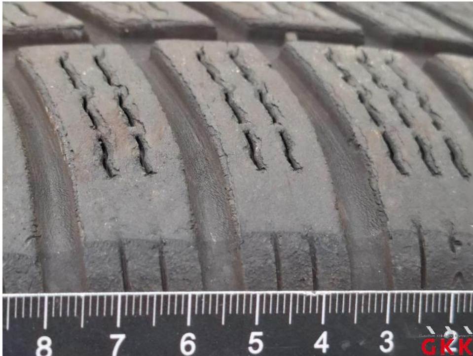
Bild 49. Reifen, 1 x beiliegend, beschädigt, ersetzen
