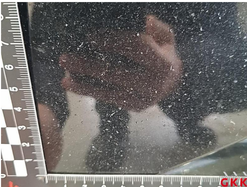
Bild 22. Stoßfänger vorne, Verkleidung -lackiert-, Steinschlag und Kratzer, lackieren
