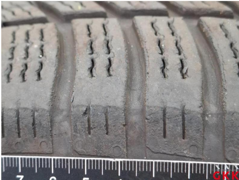
Bild 48. Reifen, 1 x beiliegend, beschädigt, ersetzen
