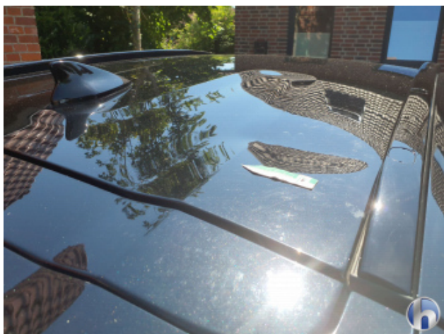
4. Dach Verdellt - Instandsetzen und Lackieren
