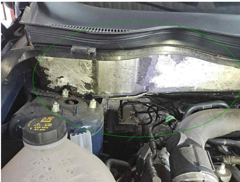
Bild 16 : Dämmmatte Wasserkasten vorne fehlt
