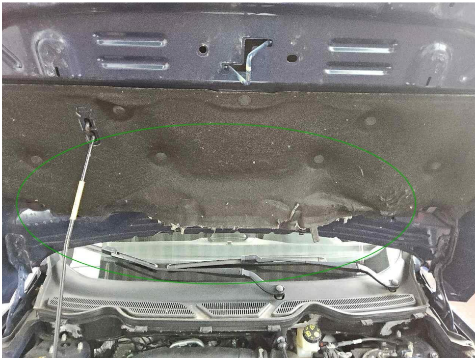
Bild 14 : Motorhaube Dämmmatte gerissen
