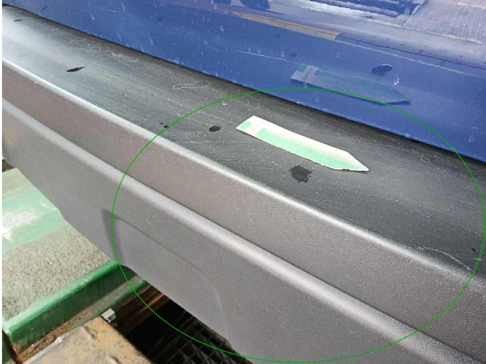
Bild 19 : Stoßstange hinten eingekerbt
