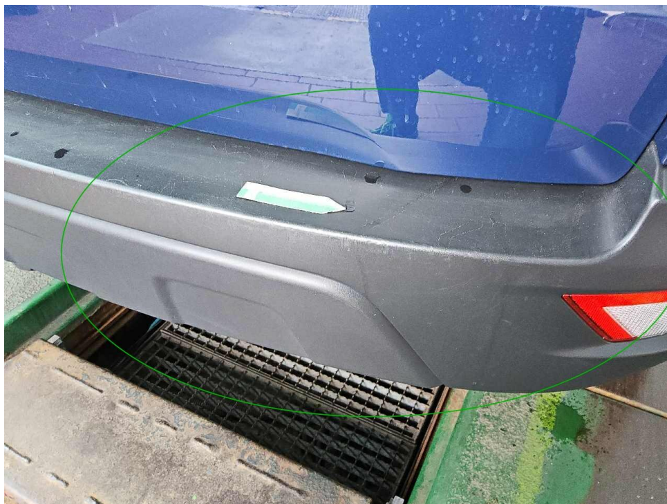
Bild 17 : Stoßstange hinten eingekerbt
