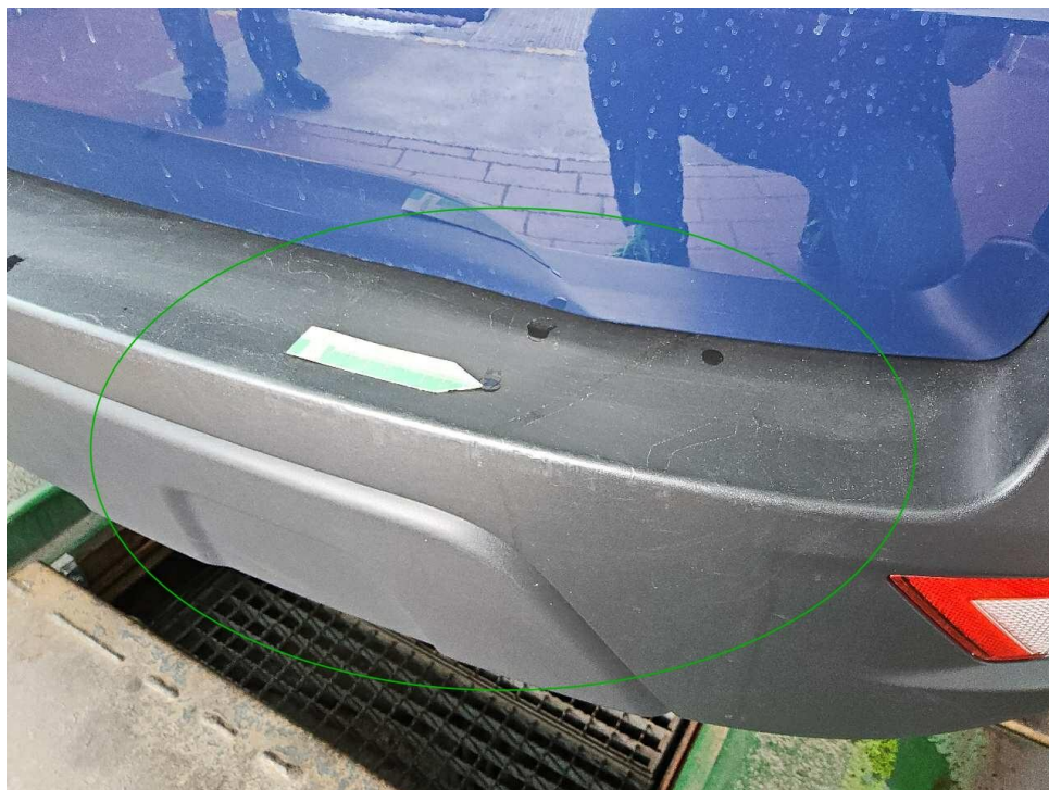
Bild 18 : Stoßstange hinten eingekerbt
