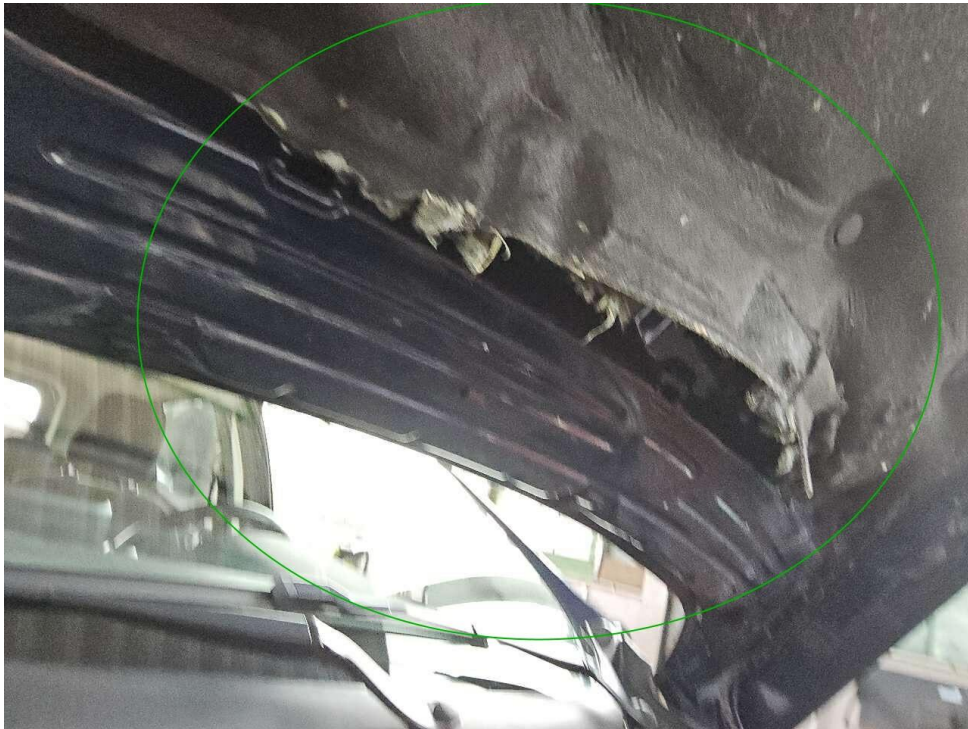
Bild 13 : Motorhaube Dämmmatte gerissen
