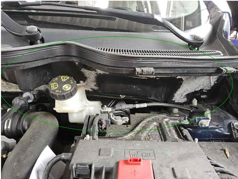
Bild 15 : Dämmmatte Wasserkasten vorne fehlt
