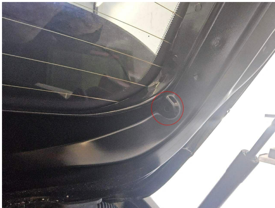
Bild 26 : Befestigungspunkte für Hutablage fehlen
