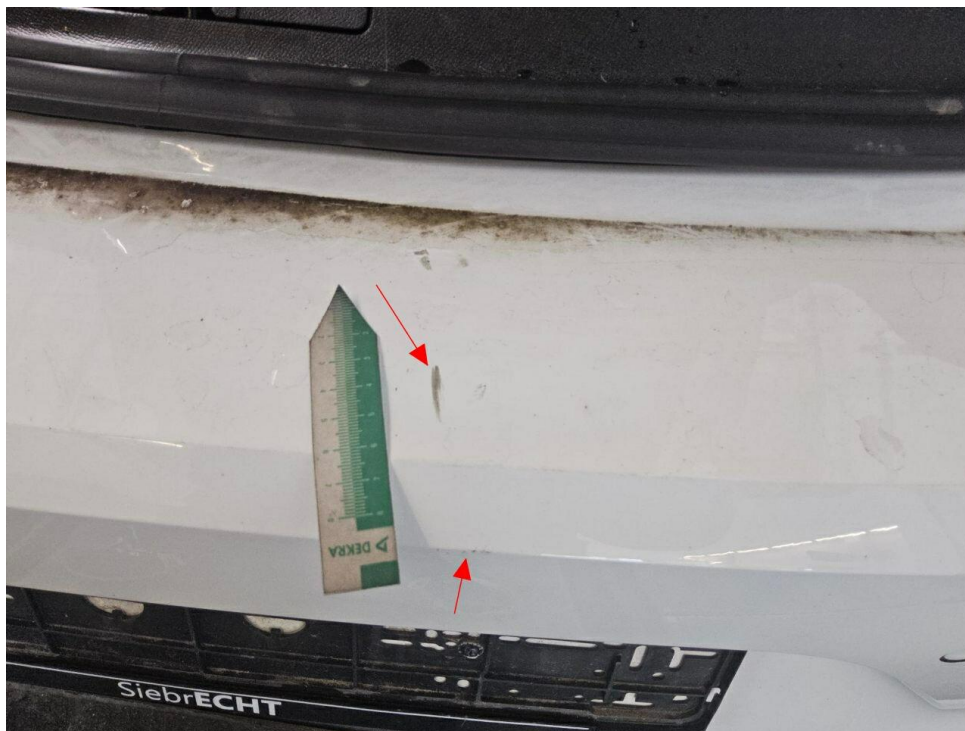
Bild 22 : Stoßfänger hinten Lackierung zerkratzt
