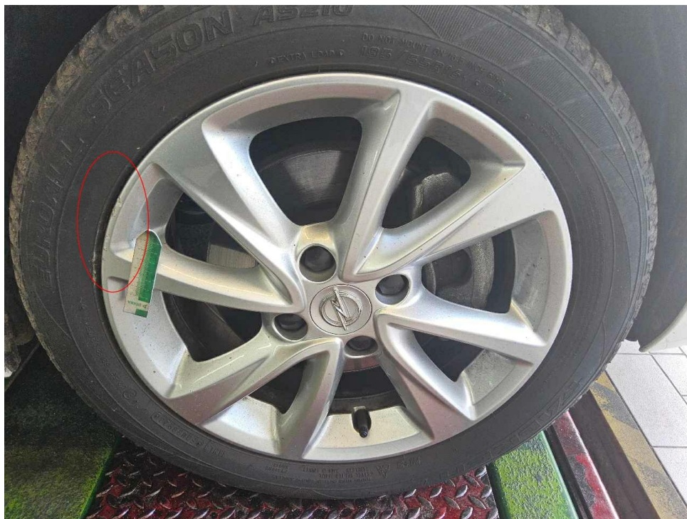
Bild 29 : Alufelge vorne rechts zerkratzt
