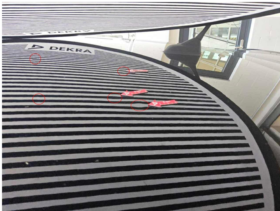
Bild 23 : Dach mehrfach eingedellt
