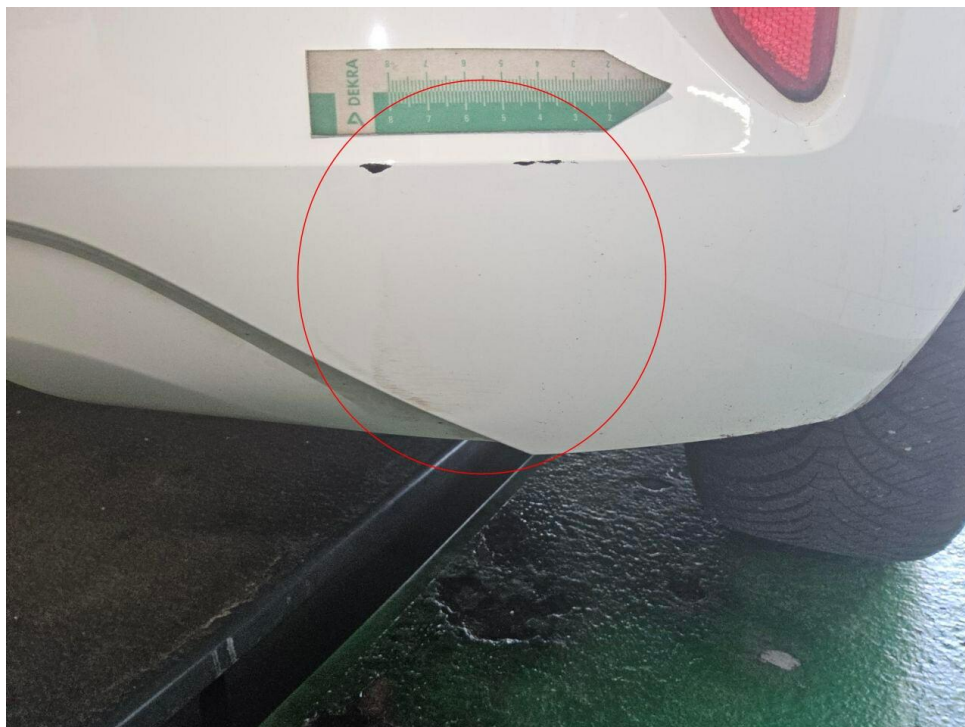
Bild 20 : Stoßfänger hinten Lackierung zerkratzt
