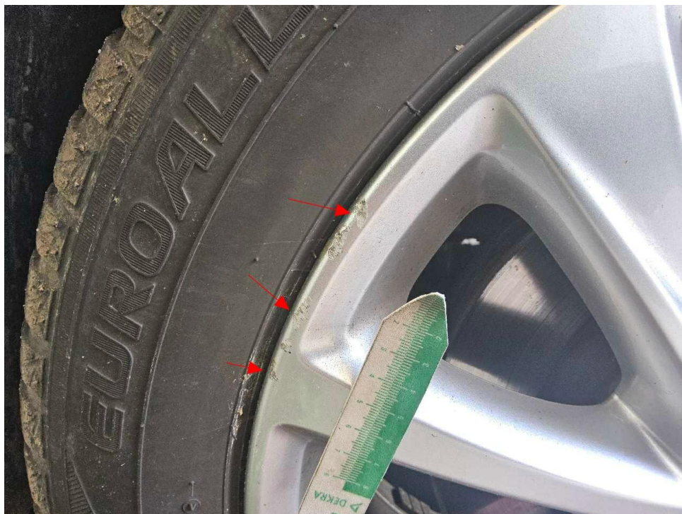
Bild 30 : Alufelge vorne rechts zerkratzt
