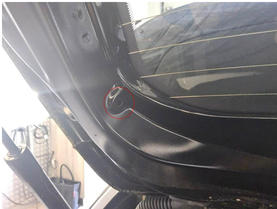
Bild 25 : Befestigungspunkte für Hutablage fehlen
