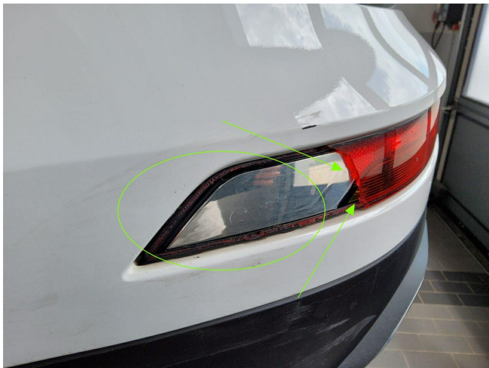
Bild 17 : Unfallschaden: Rückleuchte Glas links gebrochen
