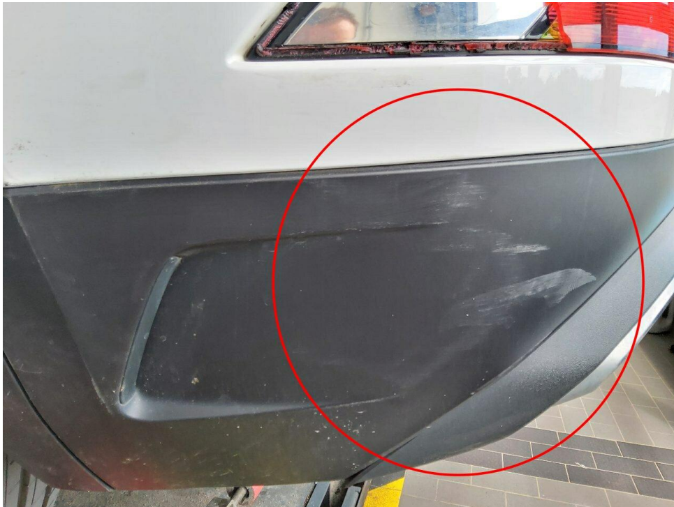
Bild 18 : Unfall Schaden: Stoßfängerverkleidung/Spoiler oberhalb hinten links verschrammt
