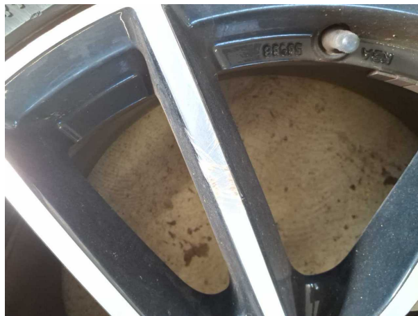
Beschädigung #1: 2.Radsatz: 1 Leichtmetallfelge - verkratzt / verschürft - kein Abzug
