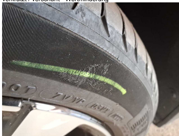
Beschädigung #6: Rad/Reifen: Reifen vorn links - beschädigt... erneuern
