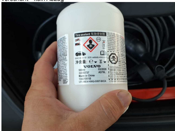
Beschädigung #2: Ausrüstung: Tirefit Füllmittel - abgelaufen - erneuern
