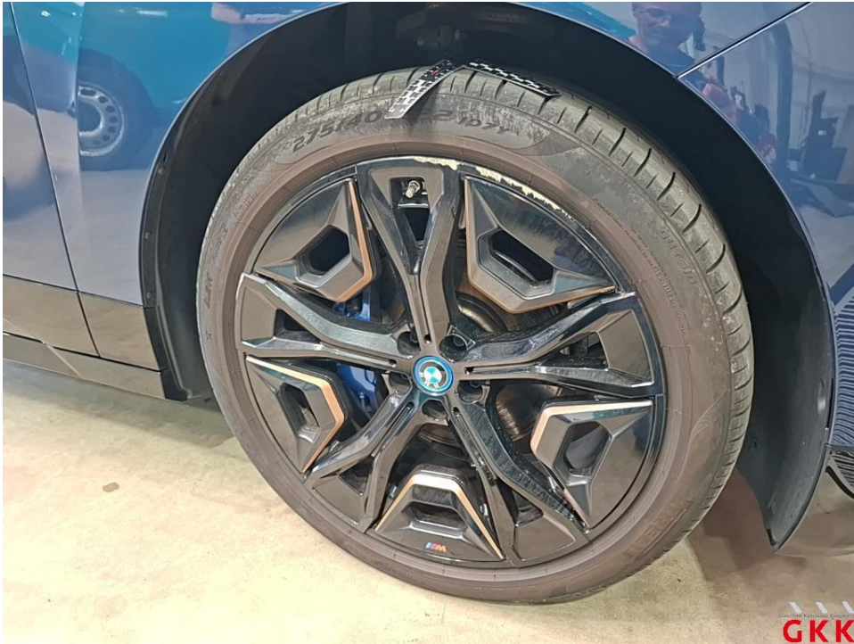
Bild 27. LM-Rad, vorne rechts, Materialabtrag, ersetzen
