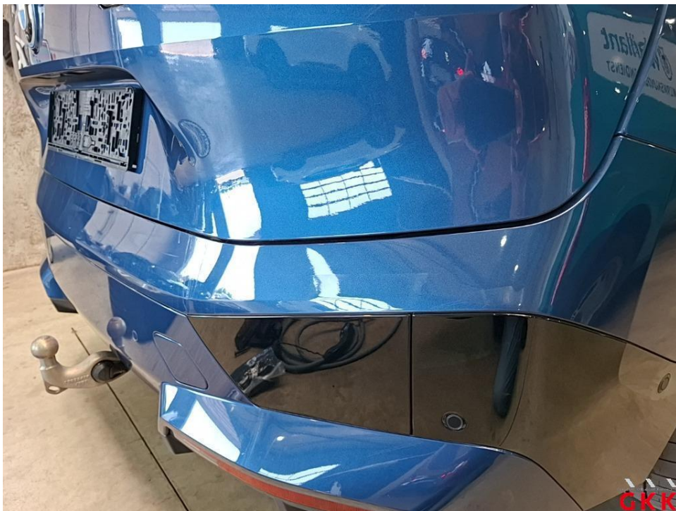
Bild 16. Stoßfänger hinten, Verkleidung -lackiert-, Lackiernebel, aufbereiten
