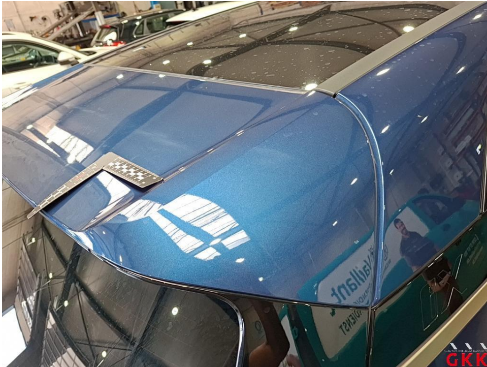
Bild 19. Heckklappe, Spoiler -lackiert-, Reparaturmangel, auslegen, schleifen, polieren
