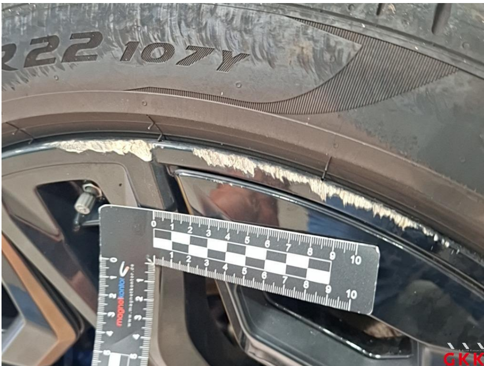
Bild 28. LM-Rad, vorne rechts, Materialabtrag, ersetzen
