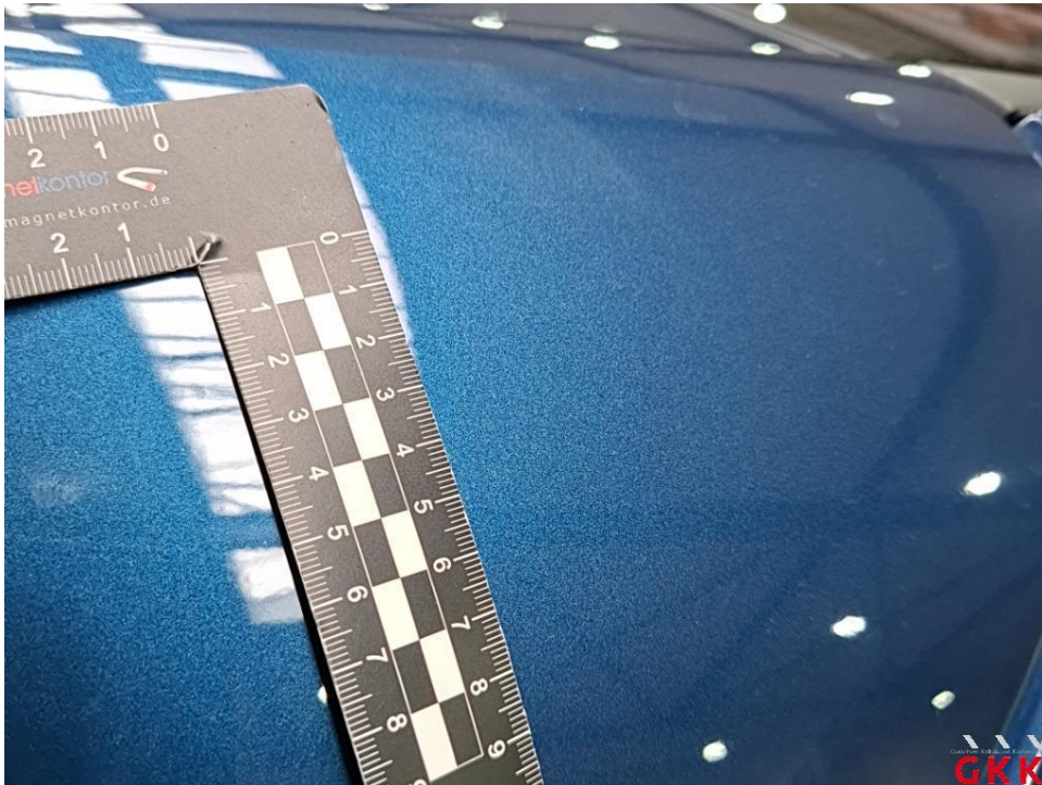
Bild 20. Heckklappe, Spoiler -lackiert-, Reparaturmangel, auslegen, schleifen, polieren
