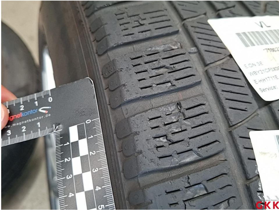
Bild 23. Reifen, 4 x beiliegend, beschädigt, ersetzen
