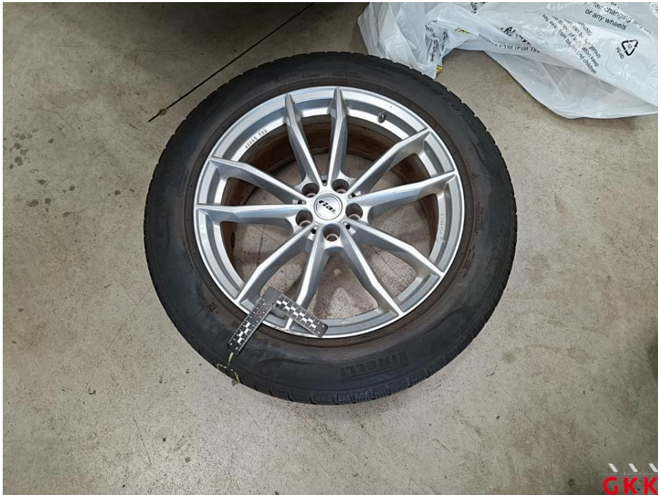
Bild 24. LM-Rad, 1 x beiliegend, Materialabtrag, ersetzen
