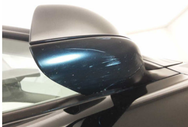
Beschädigung #5: Außenspiegel rechts: Abdeckkappe - verkratzt / verschürft - erneuern
