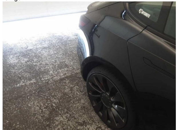
Beschädigung #3: Seitenwand rechts: Seitenwand - Delle(n) - sanft instandsetzen
