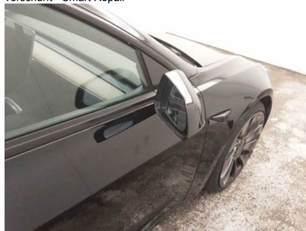
Beschädigung #5: Außenspiegel rechts: Abdeckkappe - verkratzt / verschürft - erneuern
