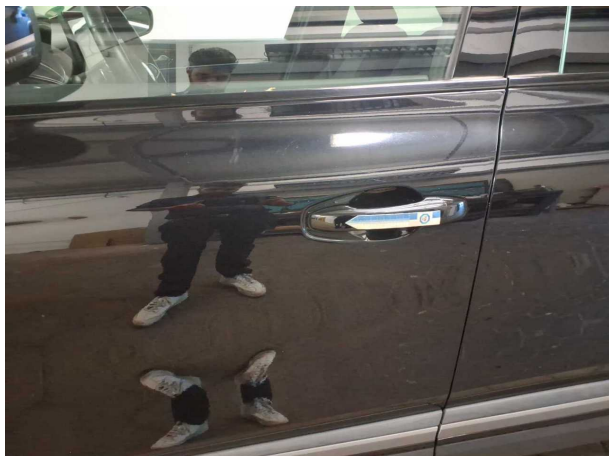
Beschädigung #1: Tür vorn links: Griff außen - verkratzt / verschürft - auslegen / polieren
