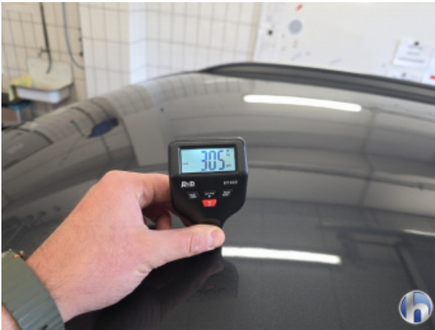
1. Dach Nachlackiert - Ohne Reparatur
