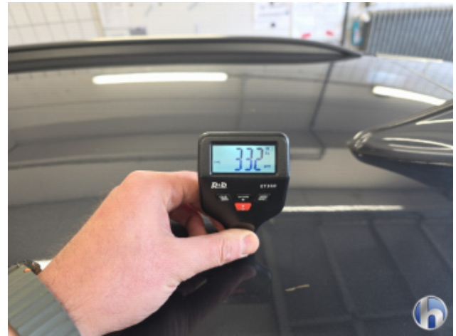
1. Dach Nachlackiert - Ohne Reparatur
