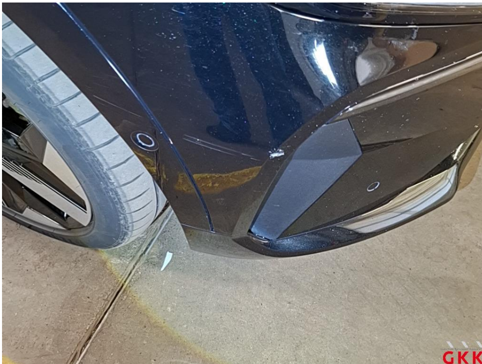
Bild 18 Stoßfänger vorne, Verkleidung -lackiert-, verkratzt, lackieren
