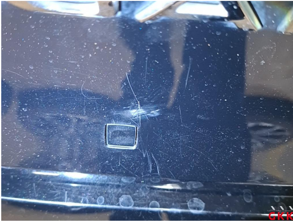
Bild 27 Heckklappe, unterhalb, verkratzt, lackieren
