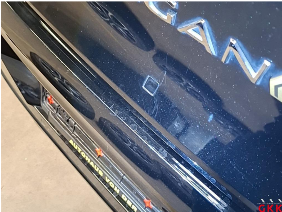
Bild 26 Heckklappe, unterhalb, verkratzt, lackieren
