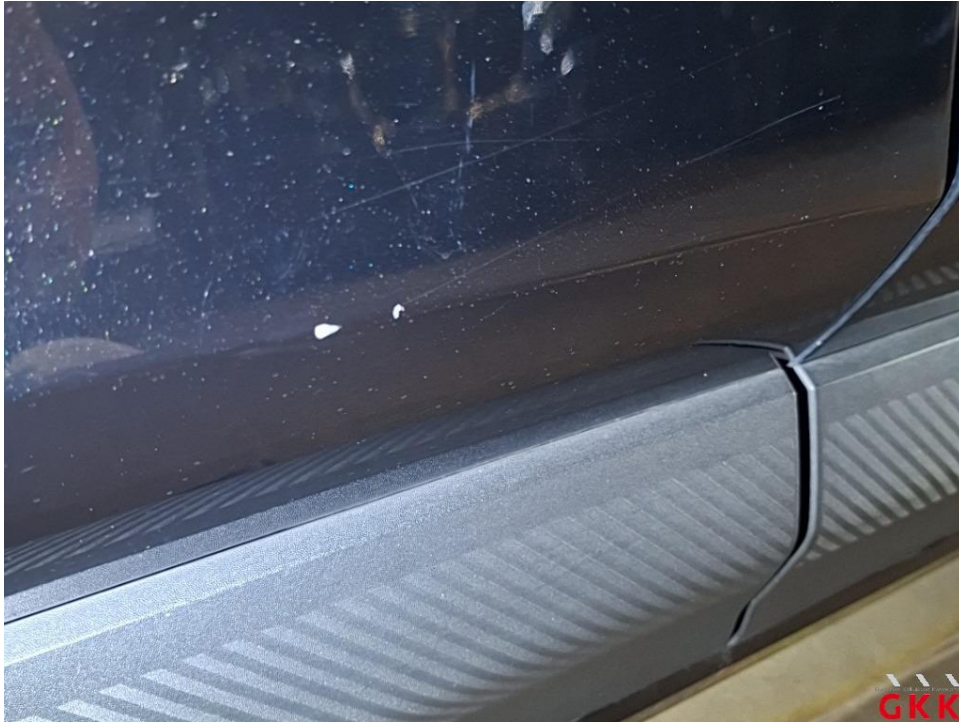
Bild 29 Tür hinten rechts, verkratzt, lackieren
