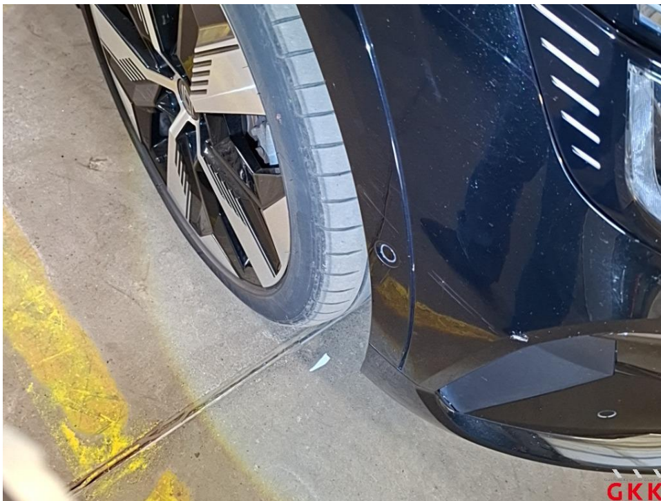
Bild 16 Kotflügel vorne rechts, Leiste, Radlauf -lackiert-, beschädigt, lackieren
