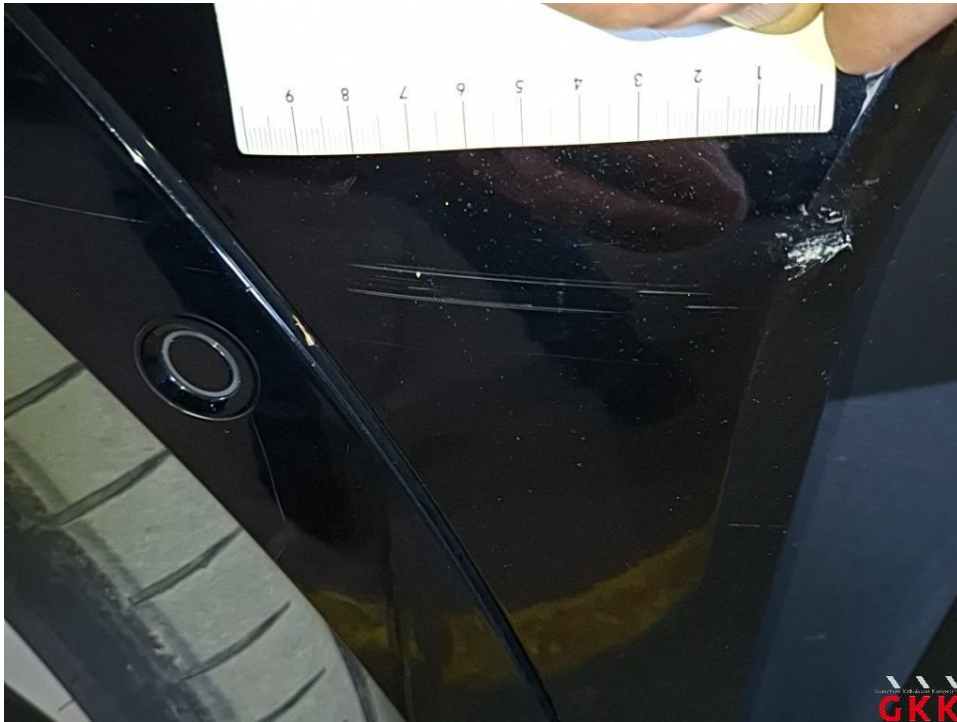
Bild 19 Stoßfänger vorne, Verkleidung -lackiert-, verkratzt, lackieren
