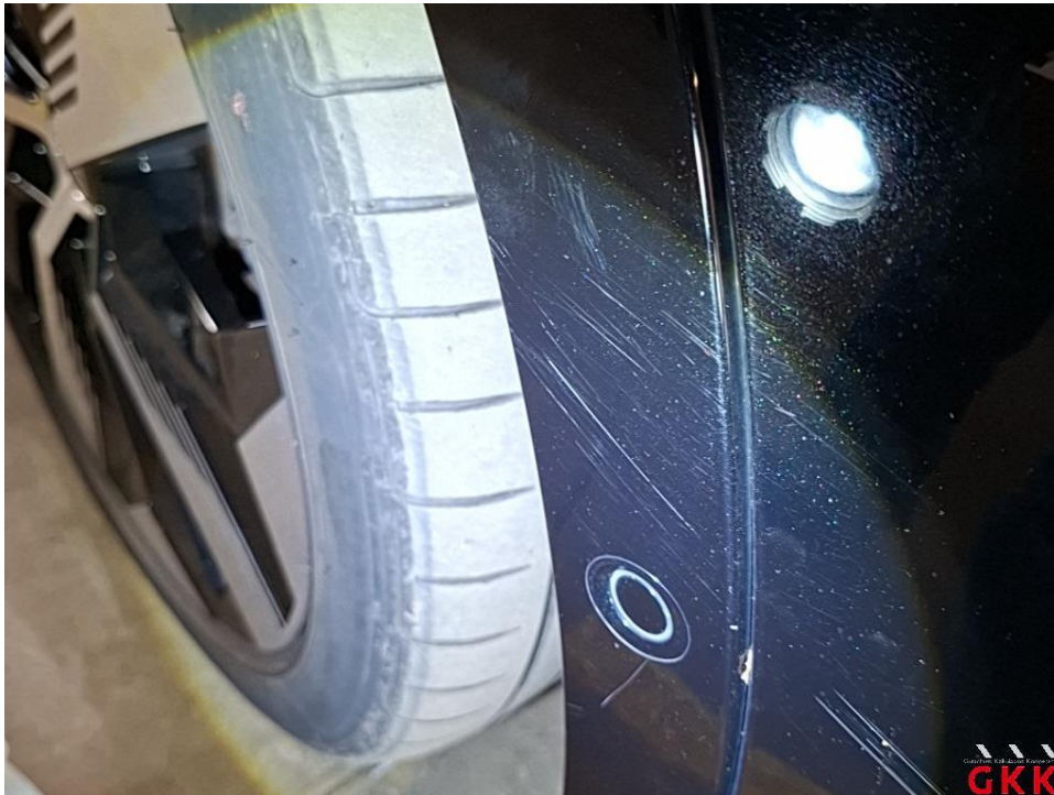
Bild 17 Kotflügel vorne rechts, Leiste, Radlauf -lackiert-, beschädigt, lackieren
