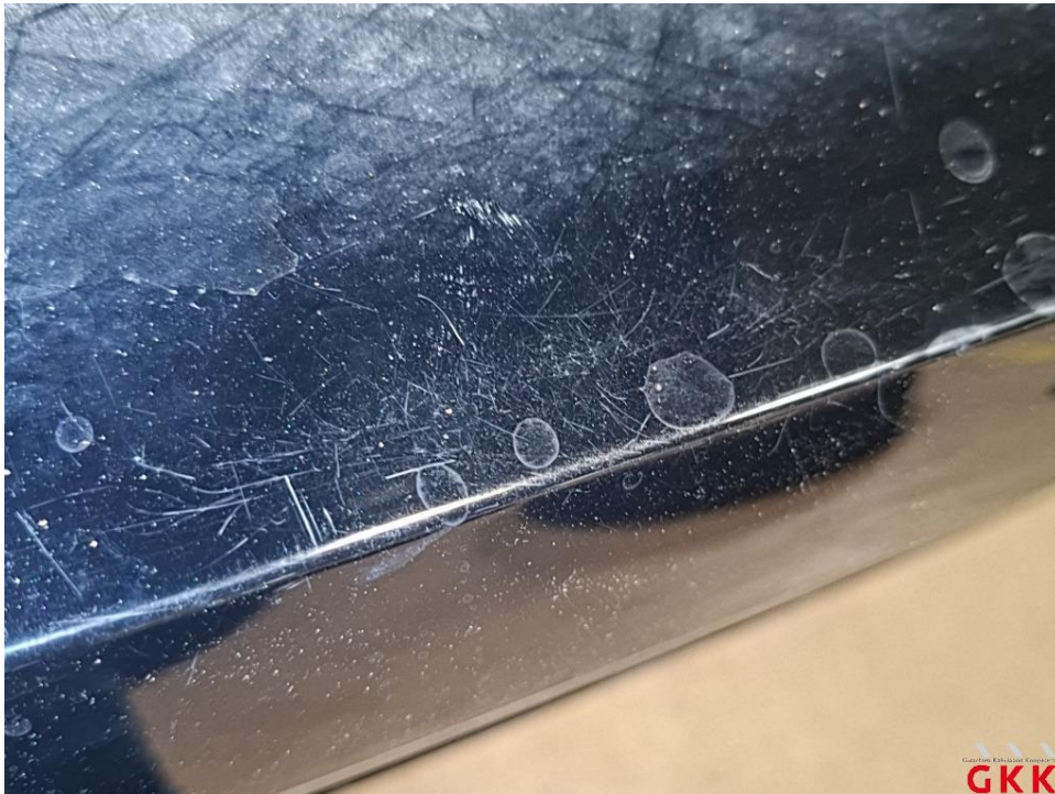
Bild 25 Stoßfänger hinten, Verkleidung -lackiert-, verkratzt, lackieren
