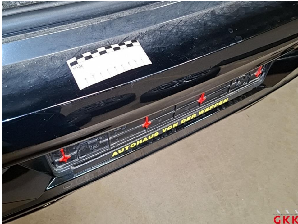
Bild 23 Stoßfänger hinten, Verkleidung -lackiert-, verkratzt, lackieren
