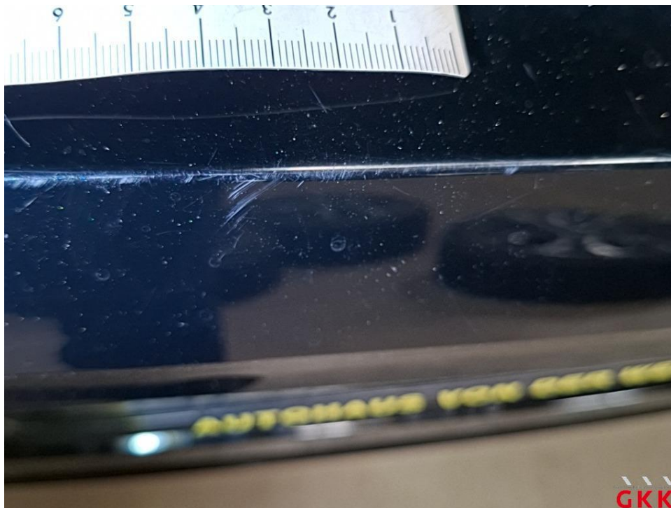
Bild 24 Stoßfänger hinten, Verkleidung -lackiert-, verkratzt, lackieren
