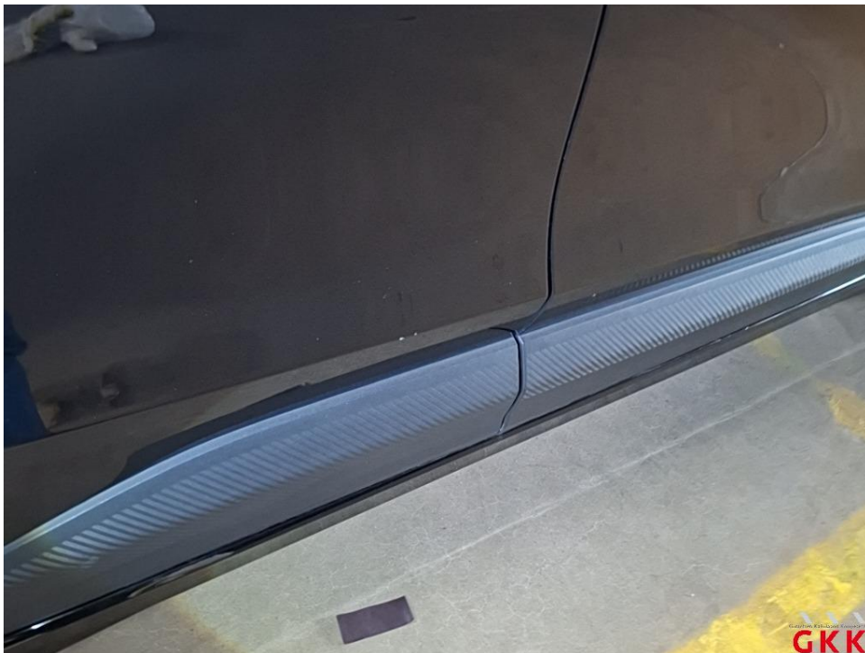
Bild 28 Tür hinten rechts, verkratzt, lackieren
