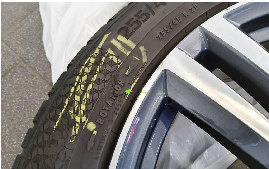
Bild 23 : Achse 1, Reifen 2 Links 1 T- Winterreifen Vorderachse links beschädigt
