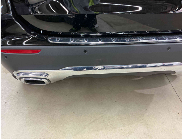
Stoßfanger hinten Verschrammung Austausch €
