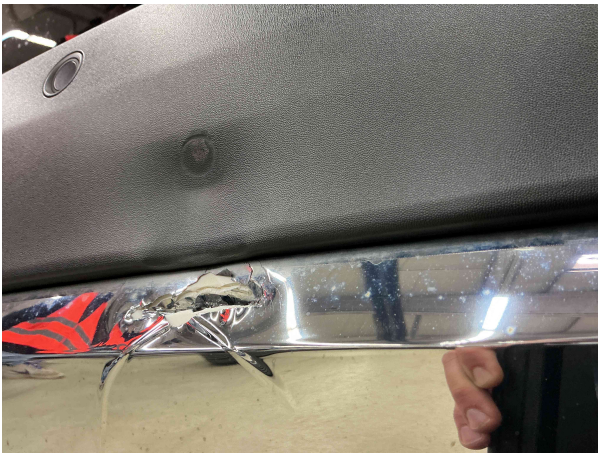
Stoßfanger hinten Verschrammung Austausch €
