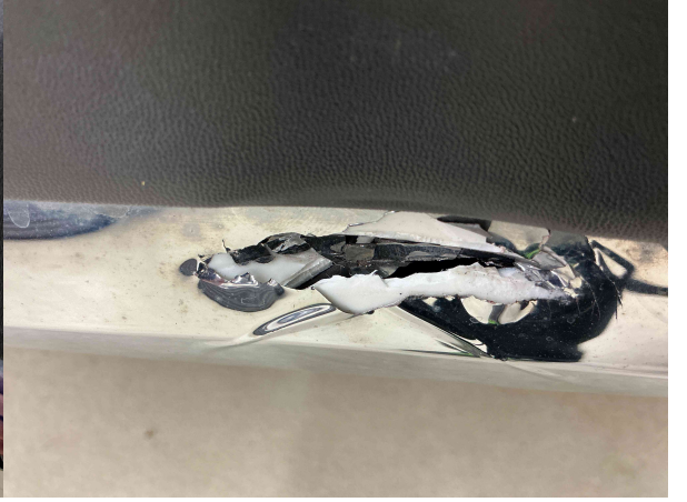
Stoßfanger hinten Verschrammung Austausch €
