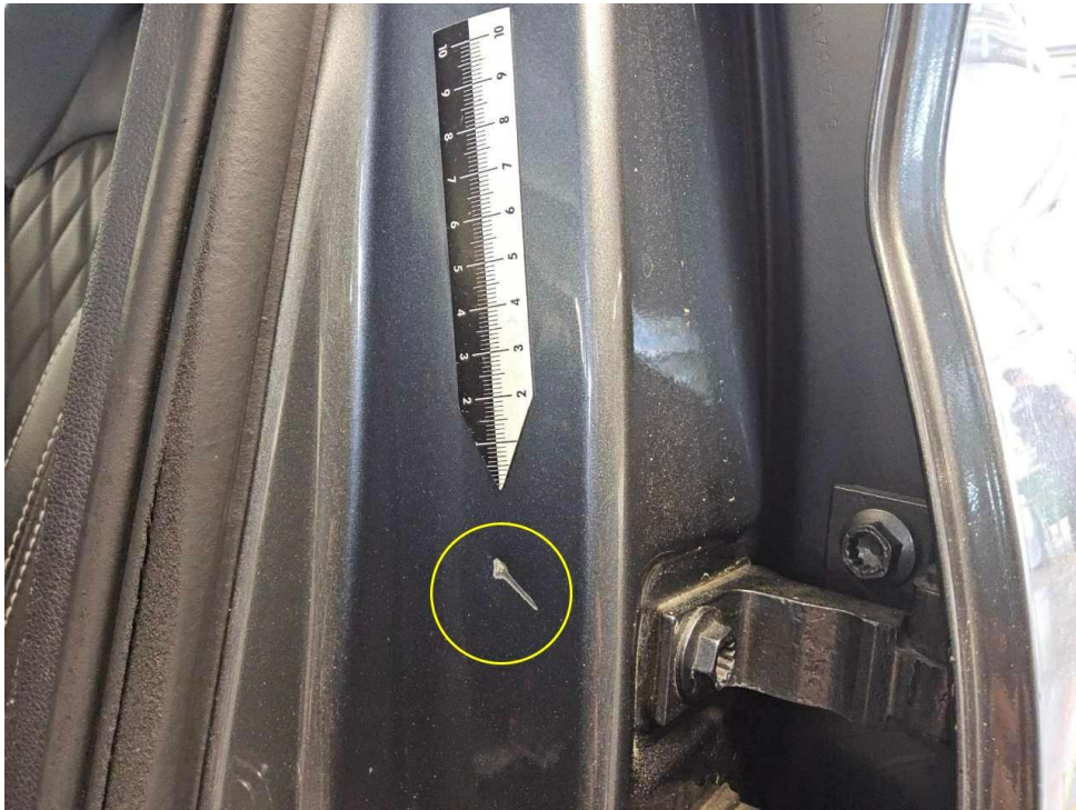
Bild 17 : Tür vorne links Einstieg Lackierung, zerkratzt, smart repair
