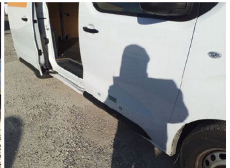
Porte / Avant Droit / Enfoncement
