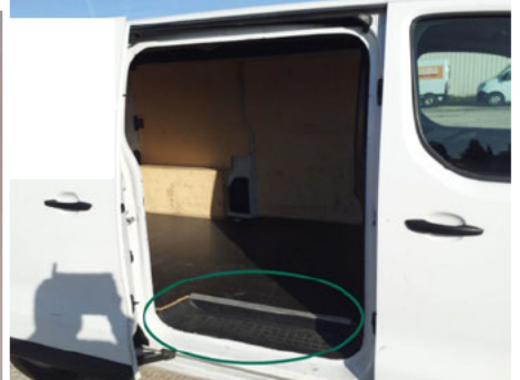
Joint de porte / Droit / Manquant
