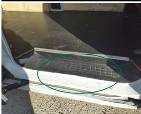
Joint de porte / Droit / Manquant
