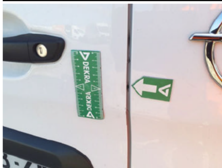
Porte / Arrière Gauche / Enfoncement
