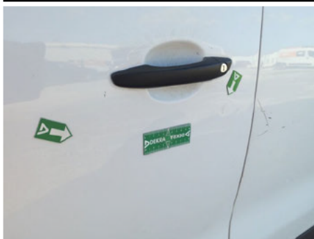
Porte / Avant Gauche / Enfoncement
