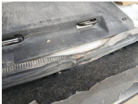
Junta de entrada de puerta / Trasero / Desgarro
