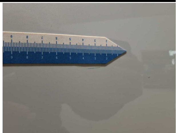
Beschädigung #5: Tür hinten links: Tür - Kratzer - lackieren
