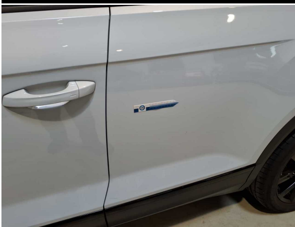
Beschädigung #5: Tür hinten links: Tür - Kratzer - lackieren
