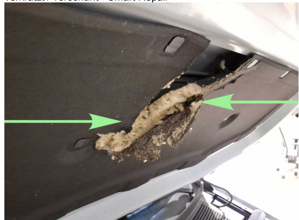
Beschädigung #2: Motorhaube: Dämmmatte - beschädigt - erneuern
