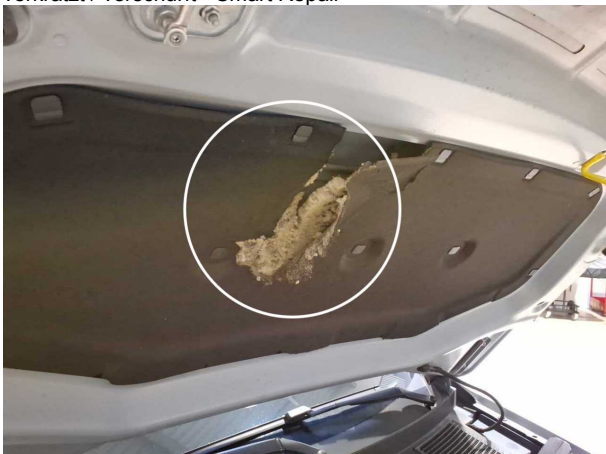
Beschädigung #2: Motorhaube: Dämmmatte - beschädigt - erneuern
