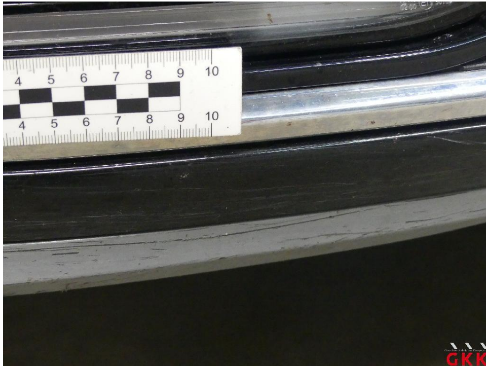
Bild 29 Stoßfänger vorne, Blende -lackiert-, verkratzt, lackieren
