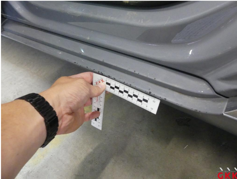
Bild 59 Schweller links, Verkleidung -lackiert-, verkratzt, lackieren
