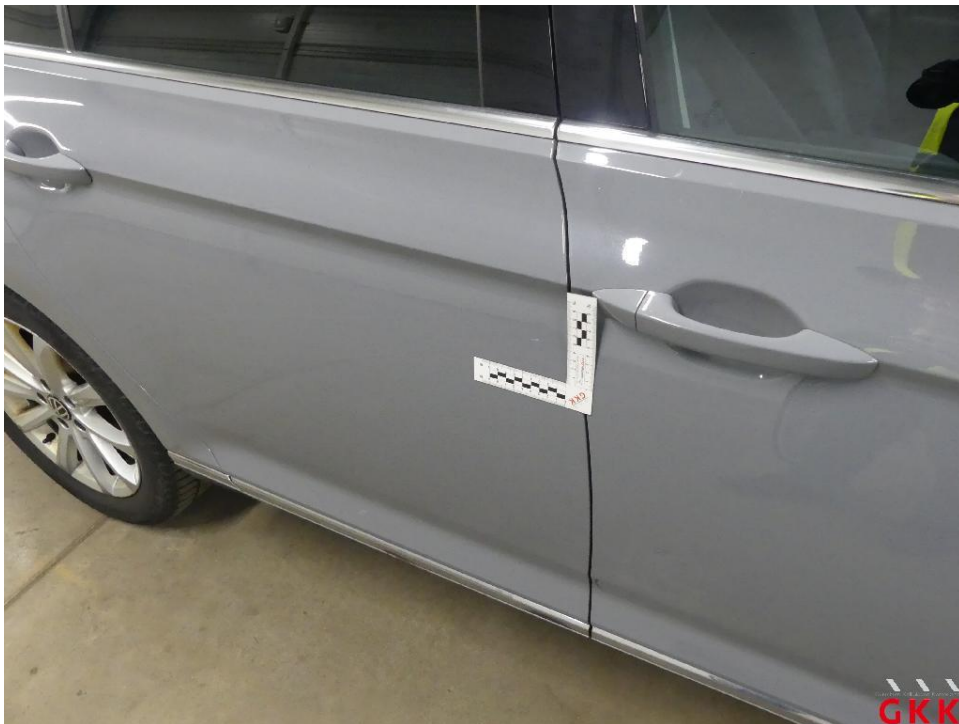
Bild 36 Tür hinten rechts, beschädigt, instand setzen - lackieren
