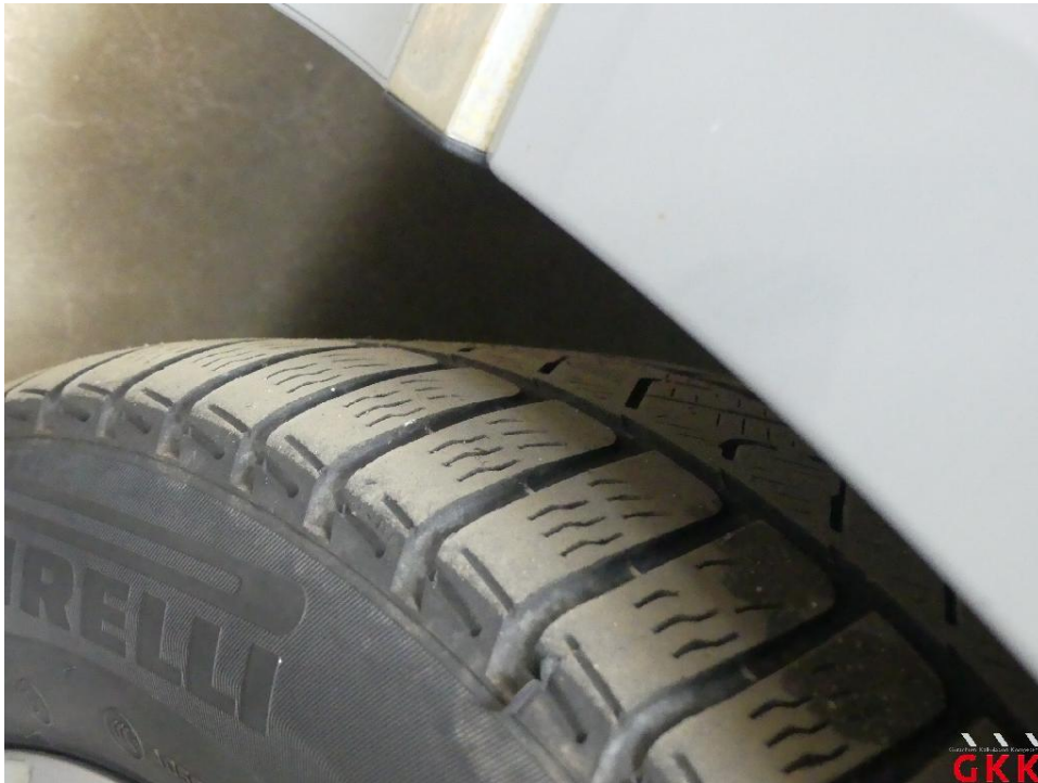
Bild 65 Reifen, vorn links und rechts, Untermaß, ersetzen
