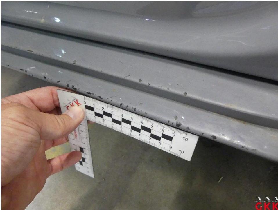
Bild 60 Schweller links, Verkleidung -lackiert-, verkratzt, lackieren
