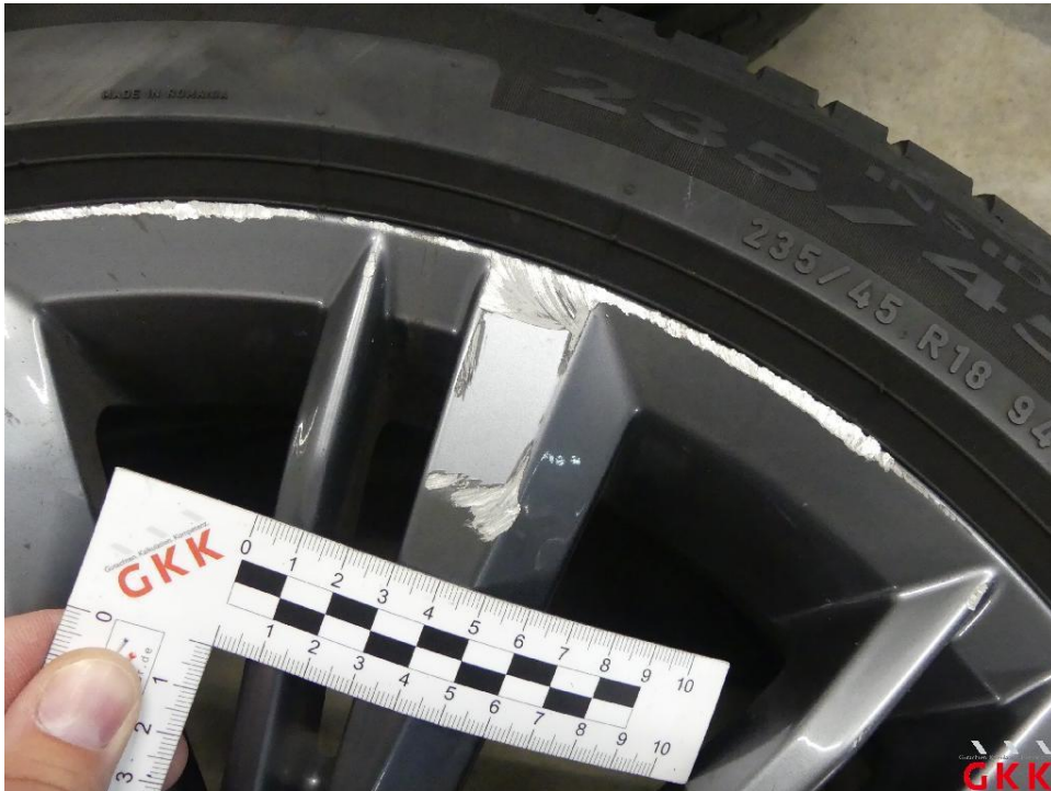
Bild 19 LM-Rad, 2 x beiliegend, beschädigt, ersetzen
