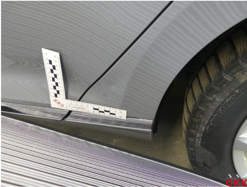
Bild 51 Seitenwand links, beschädigt, instand setzen - lackieren
