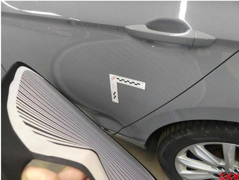
Bild 53 Tür hinten links, beschädigt, instand setzen - lackieren
