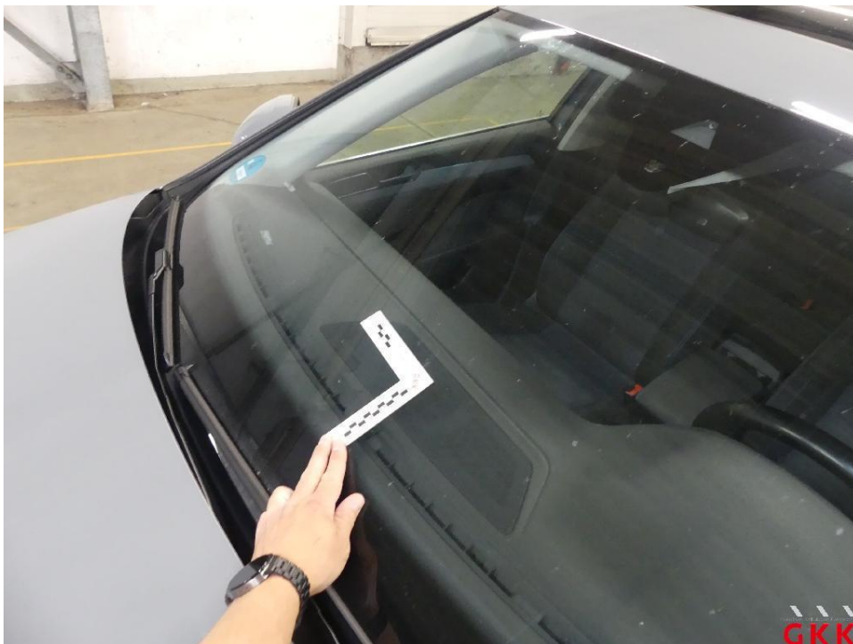
Bild 14 Frontscheibe, mit Regensensor und Frontkamera, Steinschlag mit Rissbildung, ersetzen
