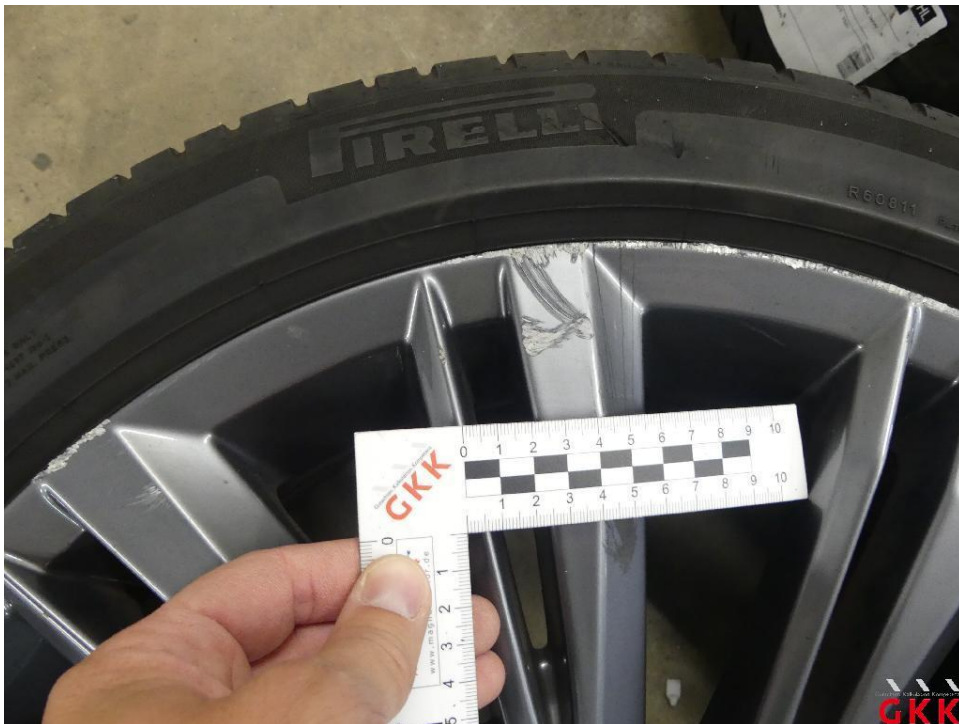
Bild 20 LM-Rad, 2 x beiliegend, beschädigt, ersetzen
