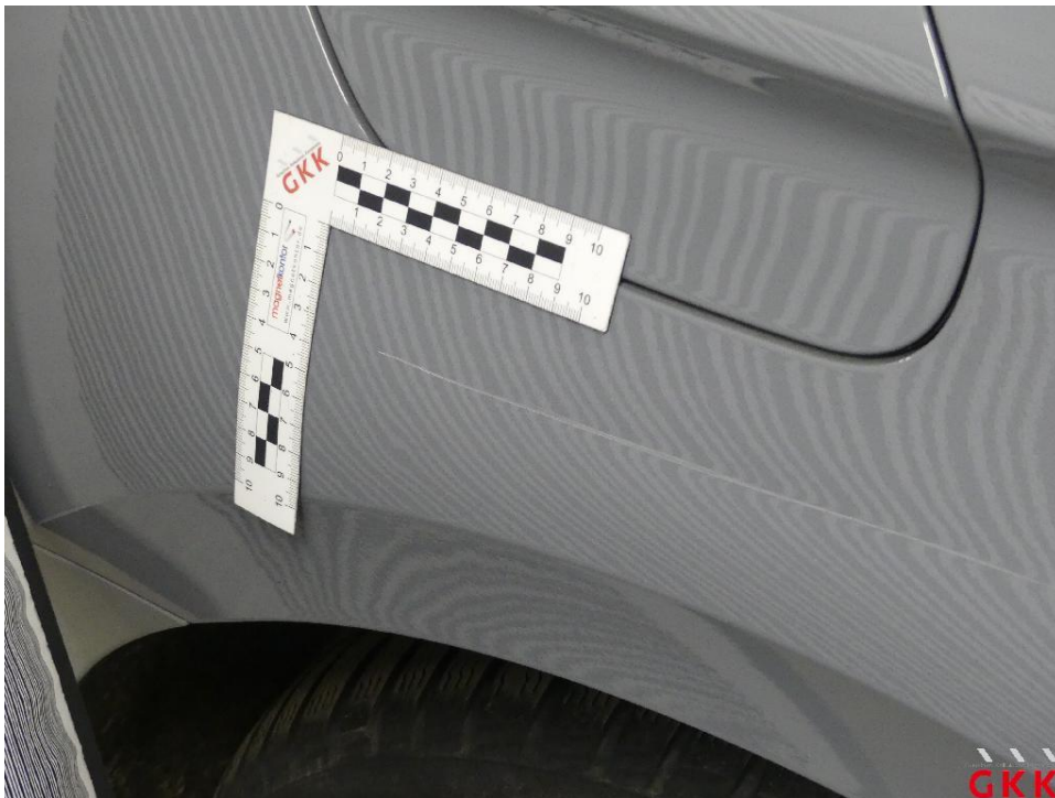
Bild 46 Seitenwand rechts, beschädigt, instand setzen - lackieren
