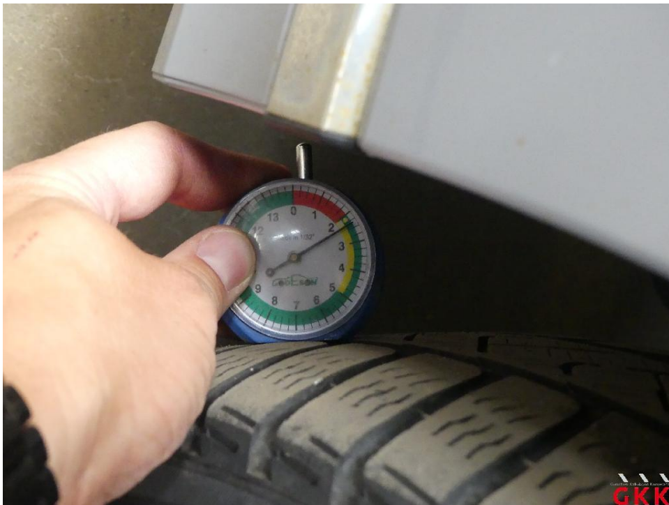
Bild 64 Reifen, vorn links und rechts, Untermaß, ersetzen
