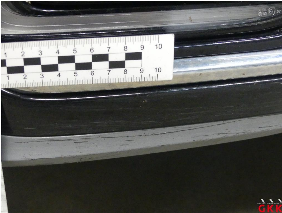
Bild 28 Stoßfänger vorne, Blende -lackiert-, verkratzt, lackieren
