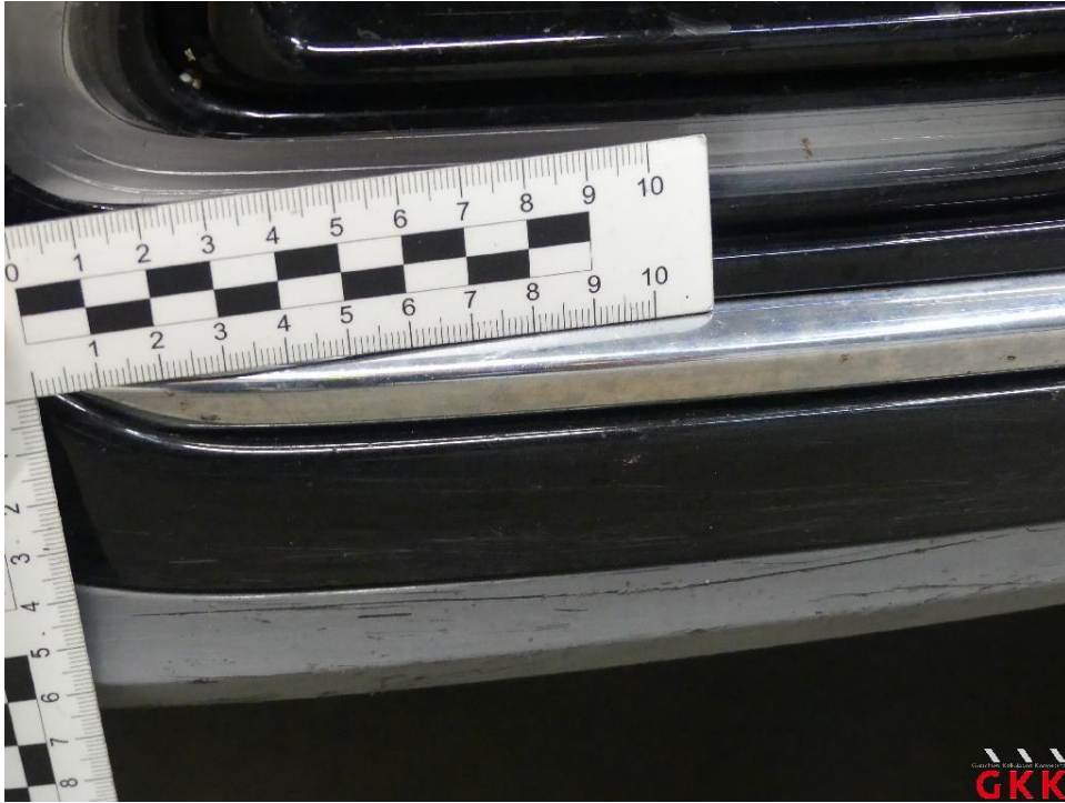
Bild 27 Stoßfänger vorne, Blende -lackiert-, verkratzt, lackieren
