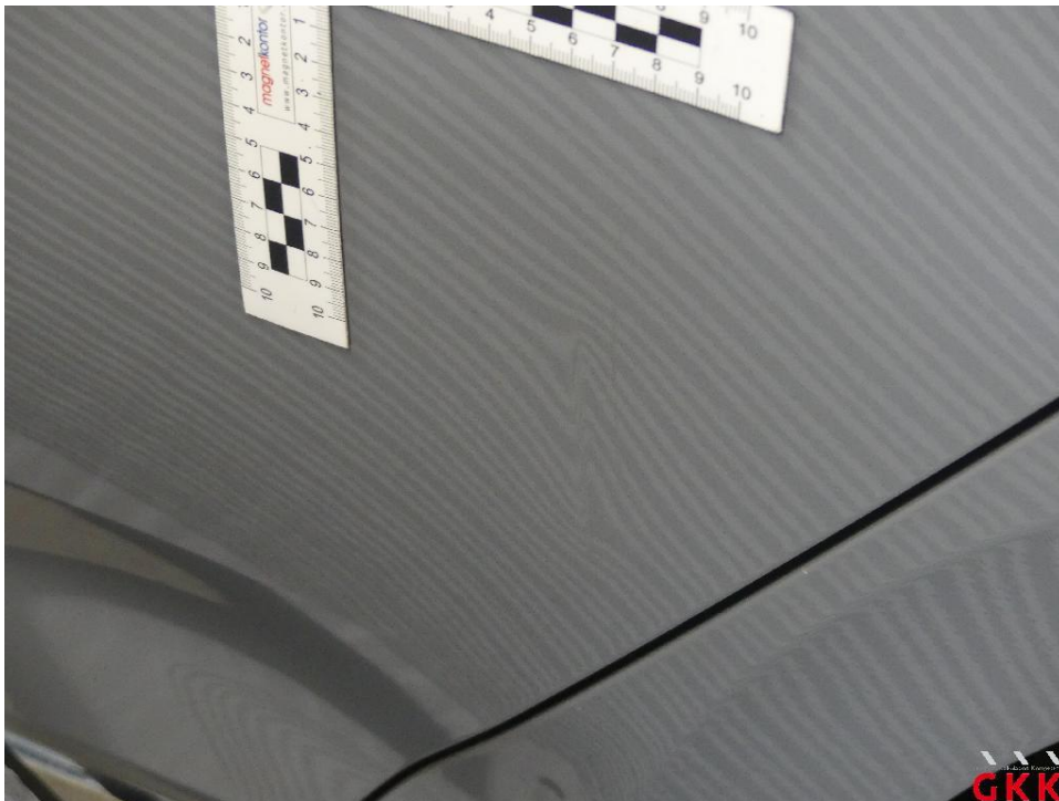
Bild 54 Tür hinten links, beschädigt, instand setzen - lackieren
