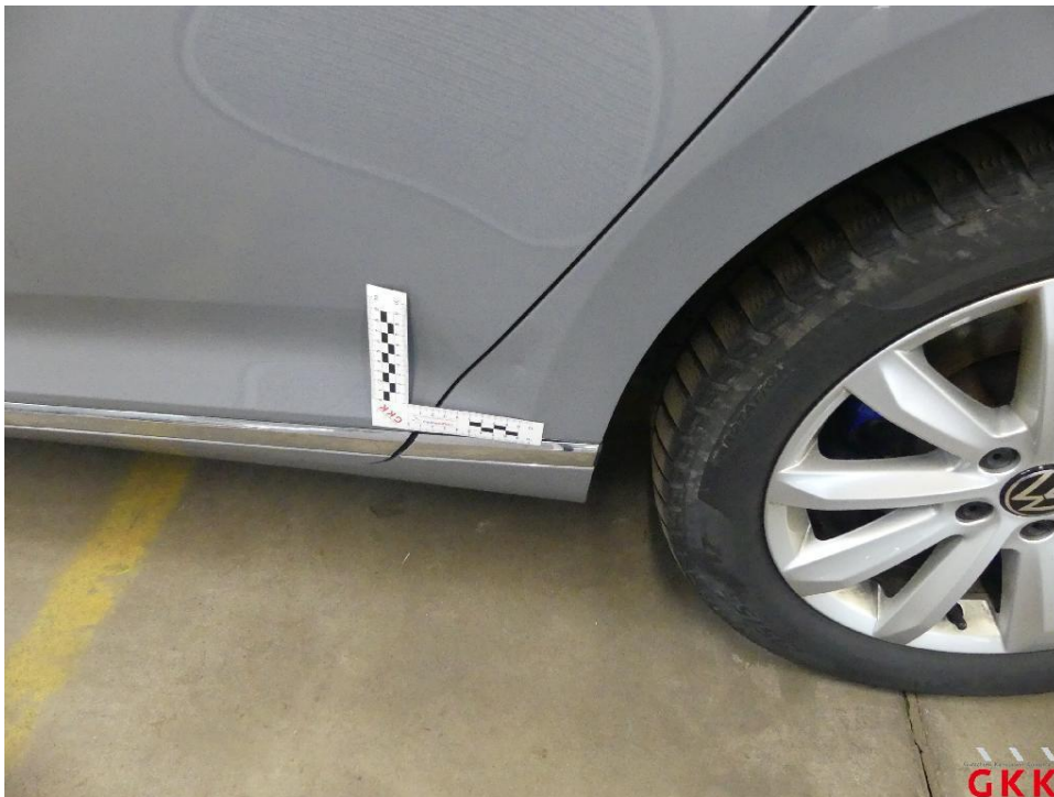
Bild 50 Seitenwand links, beschädigt, instand setzen - lackieren
