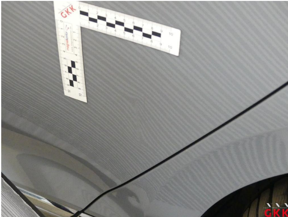
Bild 55 Tür hinten links, beschädigt, instand setzen - lackieren
