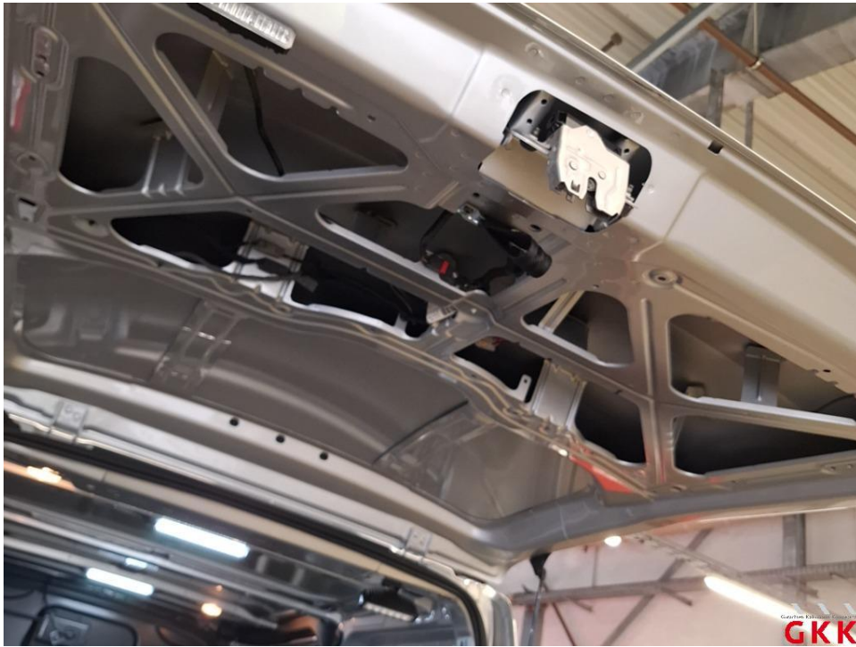
Bild 13 Heckklappe, Innenverkleidung, fehlt, ersetzen
