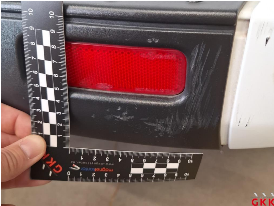
Bild 27 Stoßfänger hinten, Verkleidung -unlackiert-, verkratzt, ersetzen
