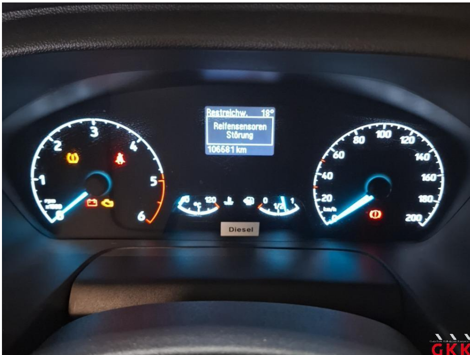
Bild 14 Kombiinstrument, Reifendruckkontrolle, aktiv, auslesen / prüfen
