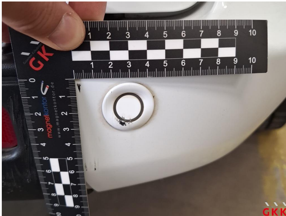
Bild 25 Stoßfänger hinten, PDC-Sensor, beschädigt, ersetzen
