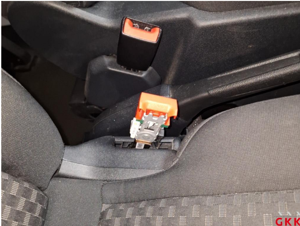
Bild 17 Sitz vorne Mitte, Gurtschloss, beschädigt, ersetzen
