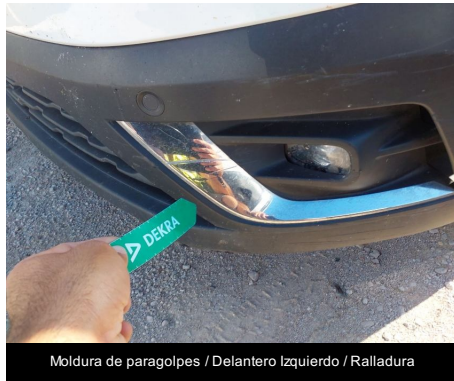
Moldura de paragolpes / Delantero Izquierdo / Ralladura
