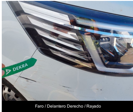
Faro / Delantero Derecho / Rayadura
