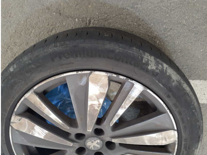
Damage 7: 2nd wheel set: 1 alloy rim (Großflächig verkratzt / mit Materialabtrag) - Scratched - Replace
