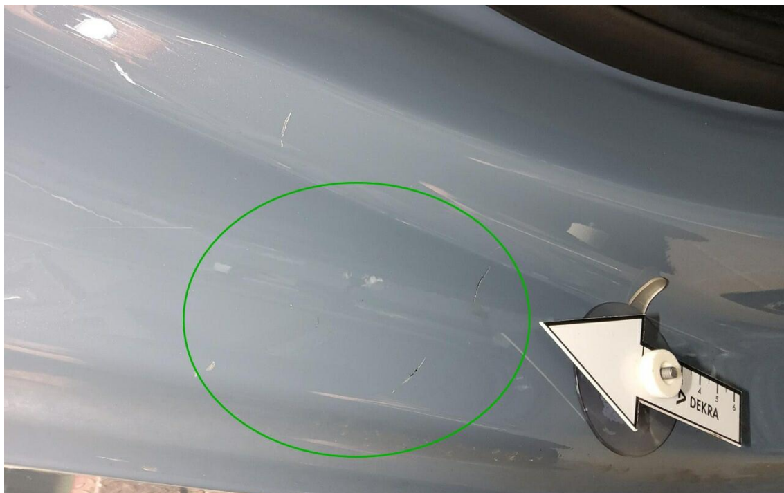
Bild 15 : Tür hinten rechts Einstieg Lackierung, zerkratzt, smart repair
