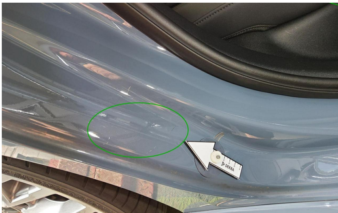
Bild 16 : Tür hinten rechts Einstieg Lackierung, zerkratzt, smart repair
