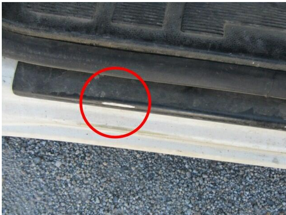
Bild 16 : Einstieg vorne links Lackabtragung Folie Einstieg vorne links schadhaft
