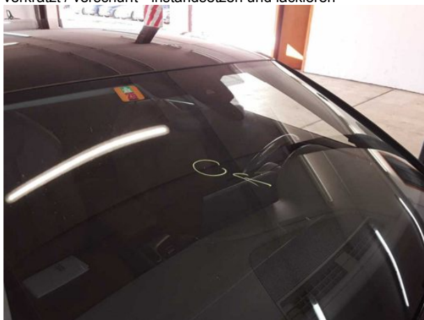
Beschädigung #13: Verglasung: Frontscheibe (Rissbildung) - Steinschlag - erneuern
