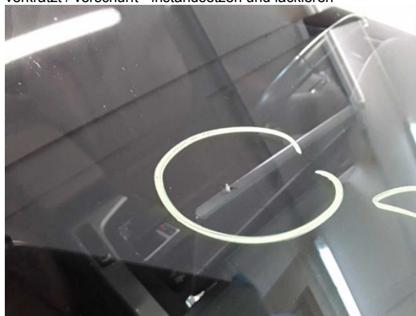
Beschädigung #13: Verglasung: Frontscheibe (Rissbildung) - Steinschlag - erneuern
