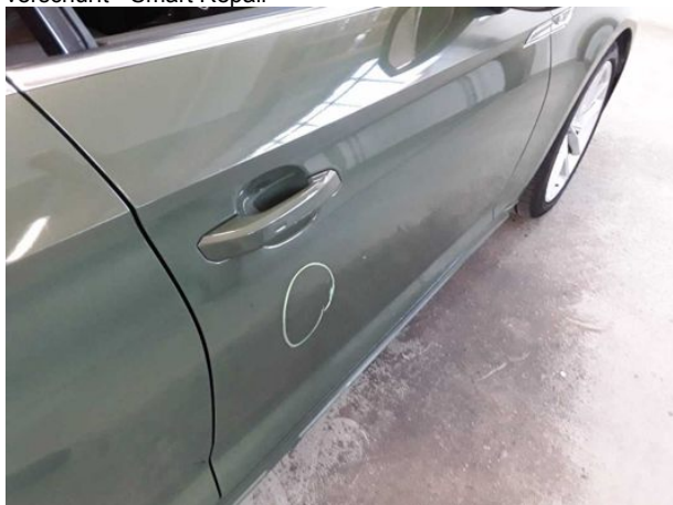
Beschädigung #10: Tür vorn rechts: Tür - Delle(n) - sanft instandsetzen
