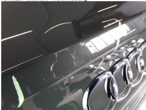
Beschädigung #8: Heckklappe/-tür: Heckklappe - verkratzt / verschürft - Smart Repair
