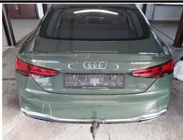
Beschädigung #8: Heckklappe/-tür: Heckklappe - verkratzt / verschürft - Smart Repair
