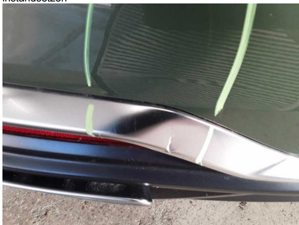
Beschädigung #11: Stossfänger hinten: Spoiler - gebrochen / gerissen - erneuern
