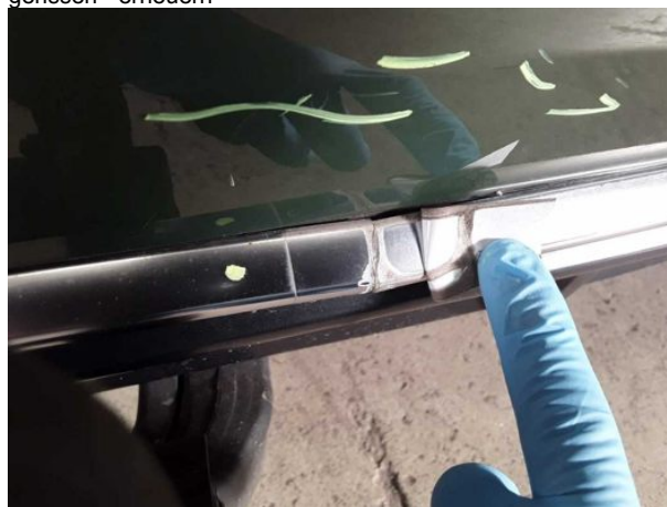
Beschädigung #11: Stossfänger hinten: Spoiler - gebrochen / gerissen - erneuern
