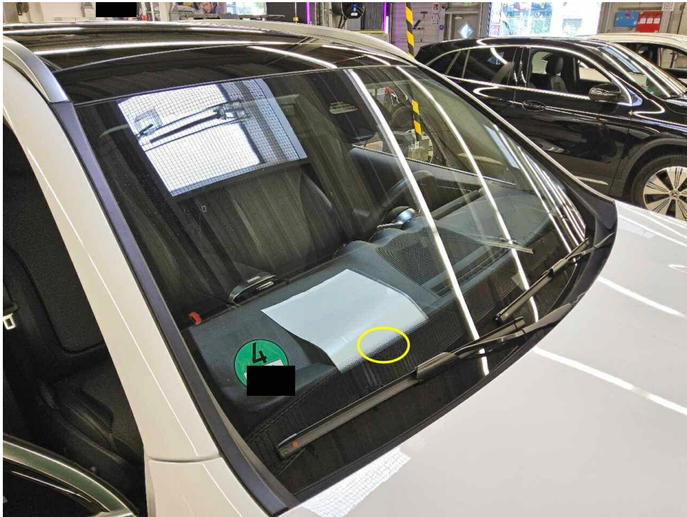
Bild 17 : Frontscheibe Steinschlag mit Rissbildung
