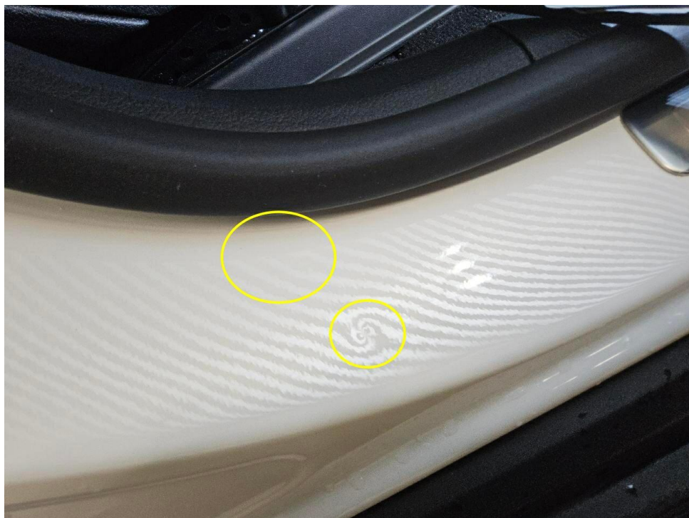
Bild 14 : Tür vorne rechts Einstieg, mehrfach eingedellt, smart repair
